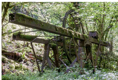
Support métallique (aval) de la transmission par câble. Phot. Jérôme Mongreville IVR43_20162500404NUC4A
