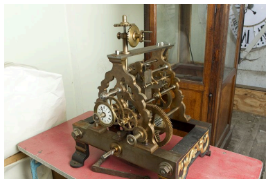
Mouvement (2010) : cadran de contrôle et roues dentées.
