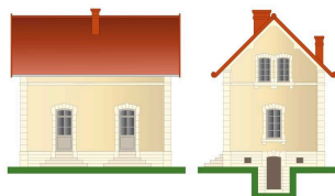
Maison d'écluser sur le canal du Nivernais : il s'agit du type "Panneçot". Dess. Alain Morelière IVR26_20145800027NUDA
