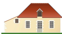
Maison éclusière sur le canal du Nivernais : il s'agit du type "Basseville".
