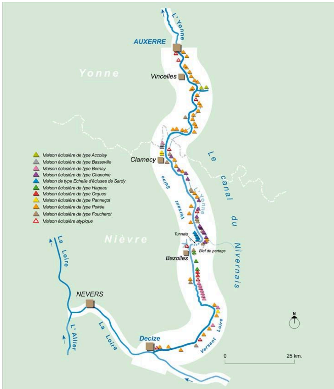
Carte générale schématique du canal du Nivernais avec la répartition des typologies de maisons éclusières.
