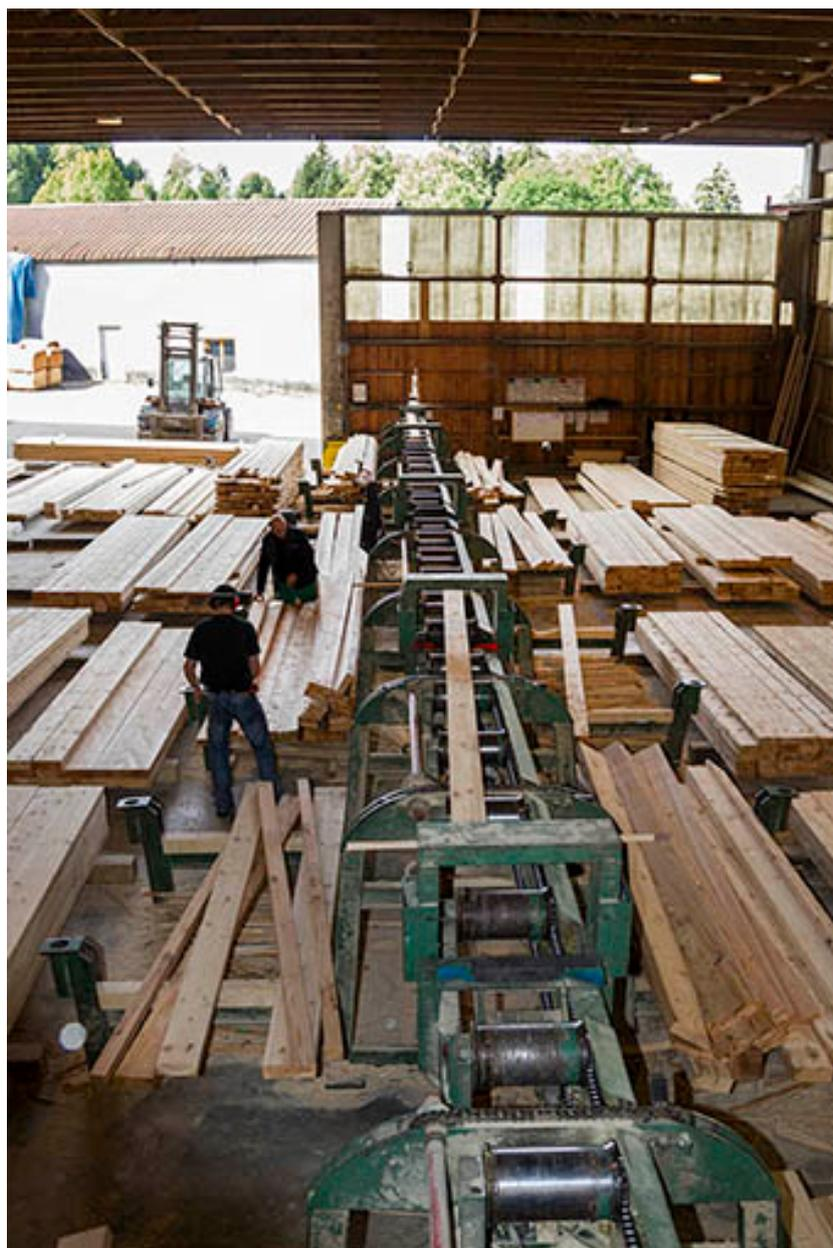
Atelier de triage et d'empilage (E) : convoyeur.
