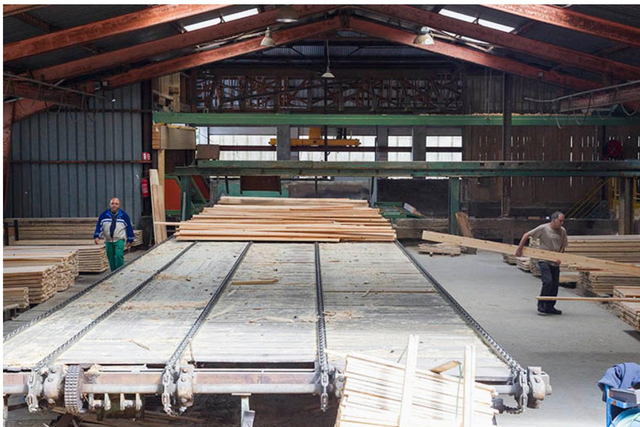
Atelier de triage et d'empilage (G) : convoyeur.
