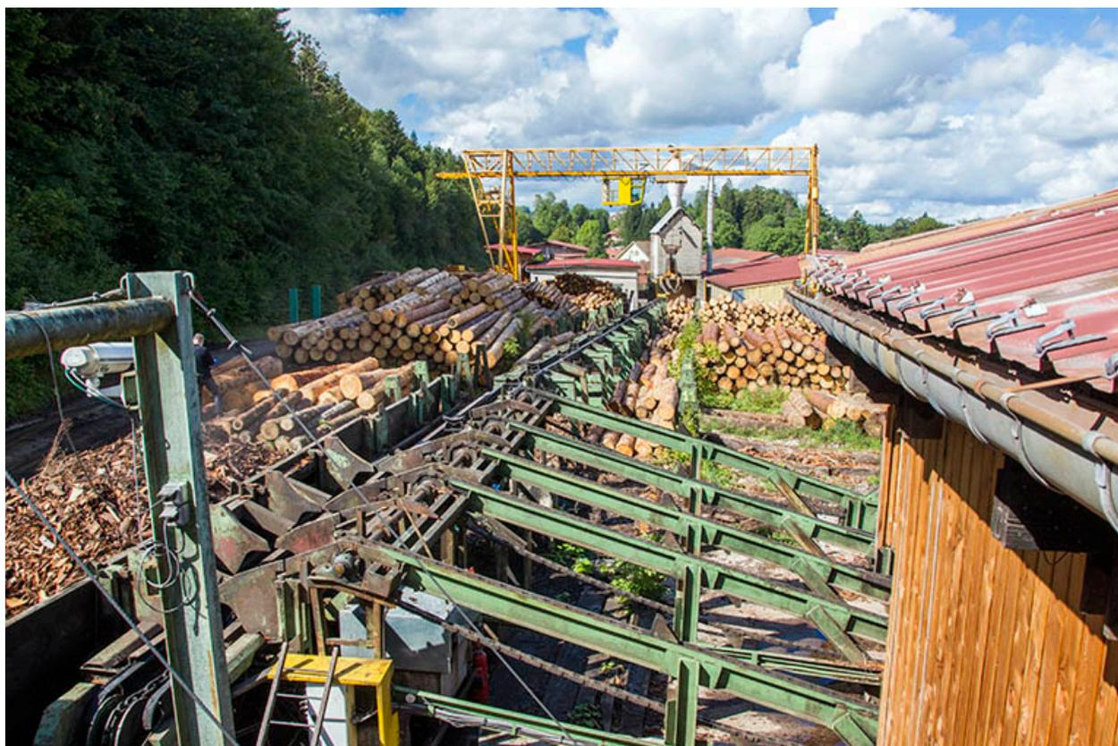
Installation de billonnage, avec le portique roulant en arrière-plan.
