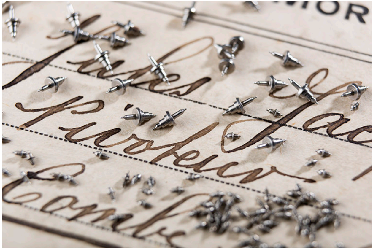
Axes de balancier destinés aux Ets Lambert Frères, de Villers-le-Lac (collection Jean-Claude Vuez, Villers-le-Lac). Le paquet porte l'inscription : "axes / 16" Dellémont / (Français) / Lambert Frères / 380-183".
