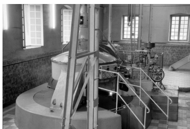
Multiplicateur et régulateur d'admission d'eau de la turbine Neyrpic. Multiplicateur Messian, régulateur à boules Neyrpic (modèle 1924 modifié 1927). Phot. Laurent Poupard IVR43_19893900258Z
