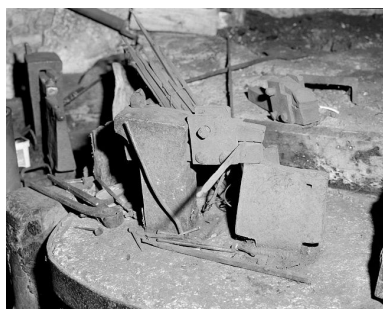
Poste de travail équipé avec une "cloutière". Phot. Jérôme Mongreville IVR43_20003900153X
