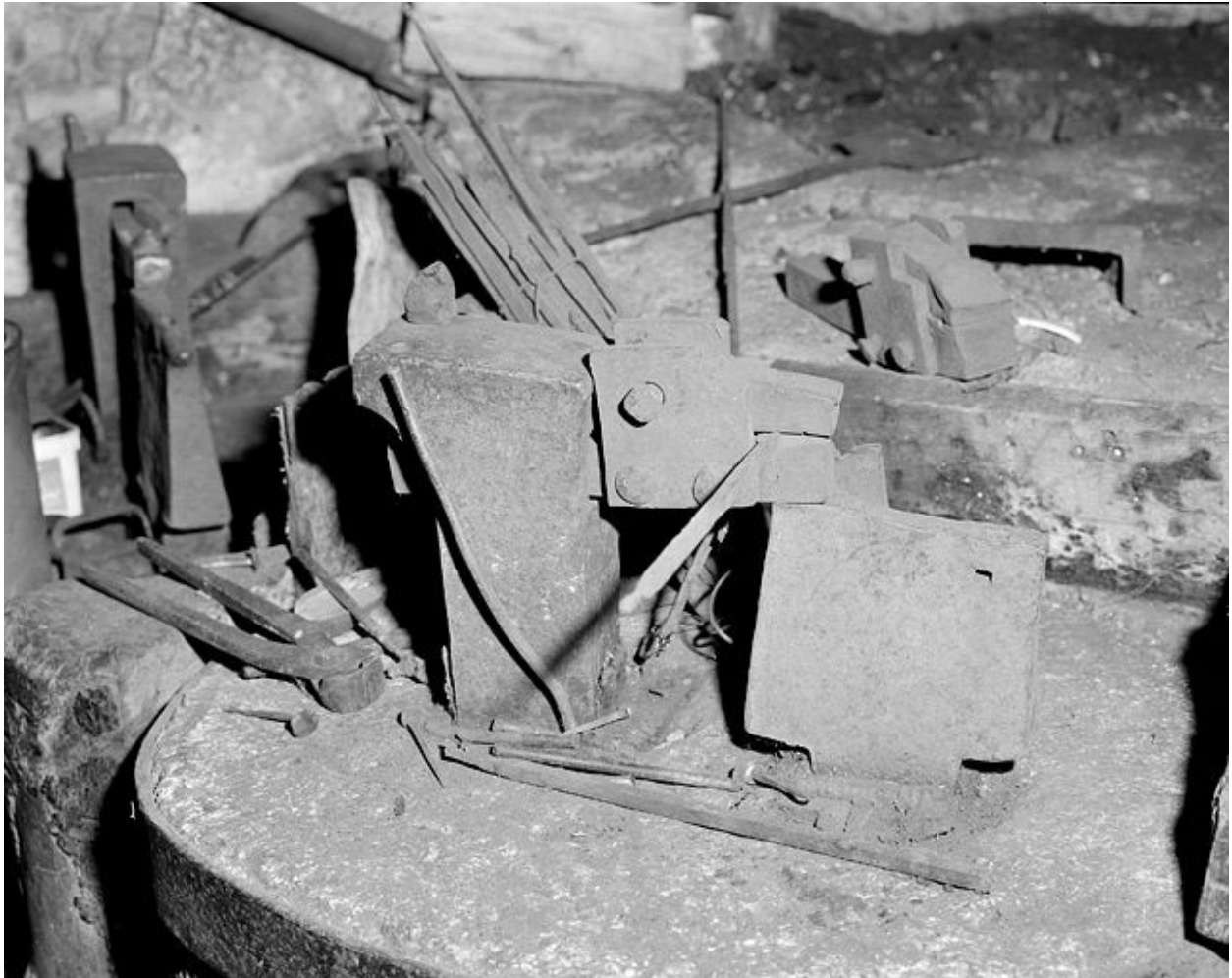
Poste de travail équipé avec une " cloutière ".
