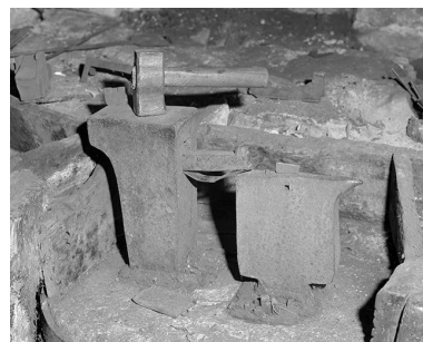
Poste de travail équipé avec la matrice pour les clous. Phot. Jérôme Mongreville IVR43_20003900152X
