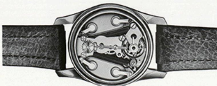
Mécanisme de la montre Electronic, dessin, s.d. [1954].
