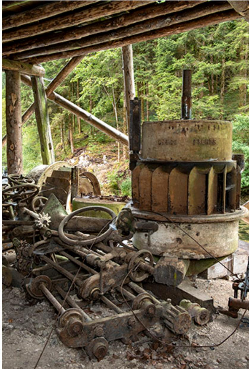
Turbine Douge et transmission démontées.
