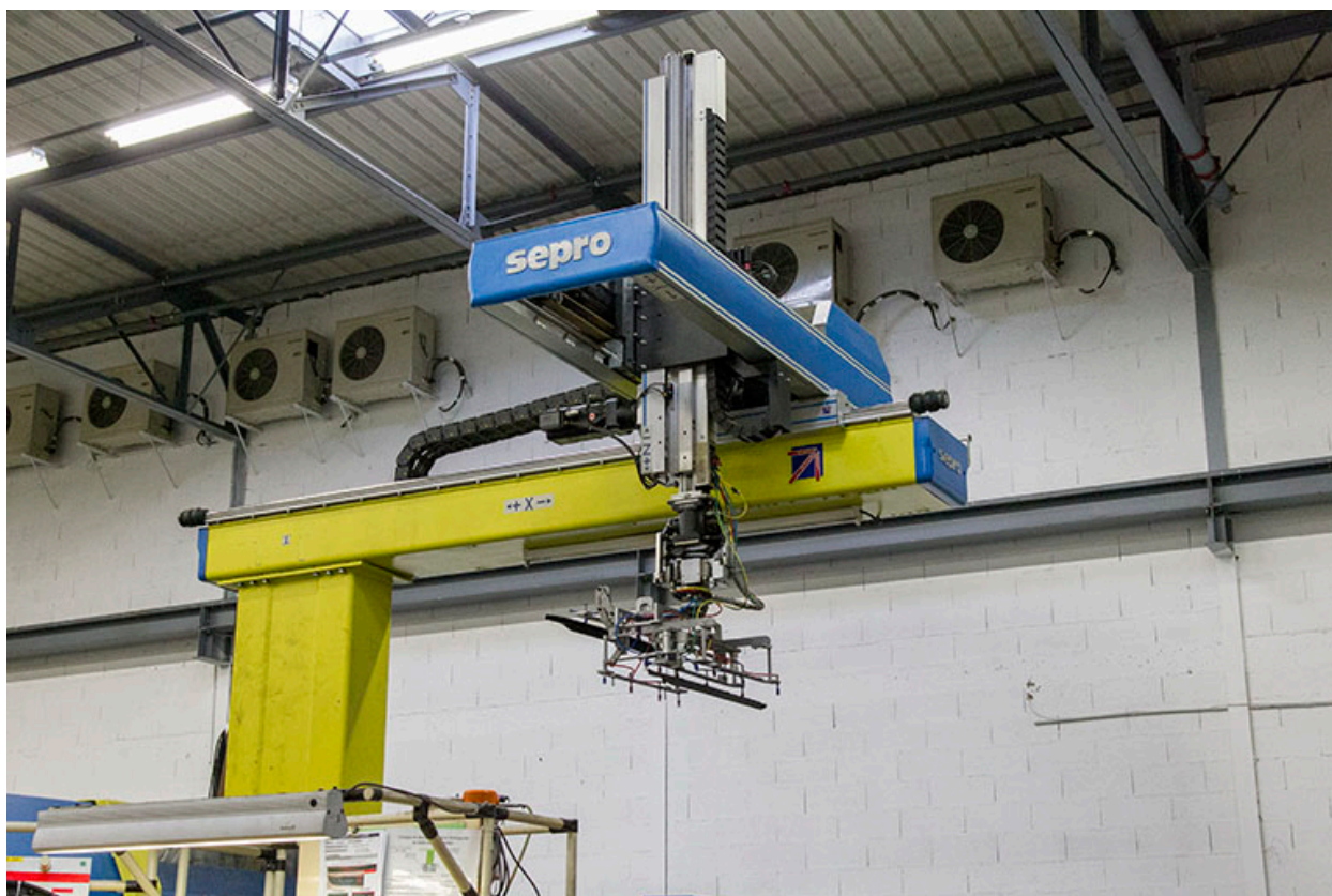
Site récent : robot de déchargement d'une presse à injecter.
