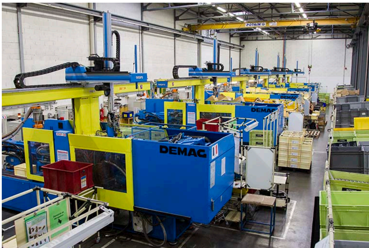
Site récent : presses d'un atelier d'injection plastique.
