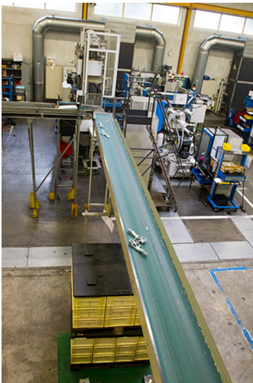
Site ancien : convoyeur à bande de l'atelier d'injection zamak.
