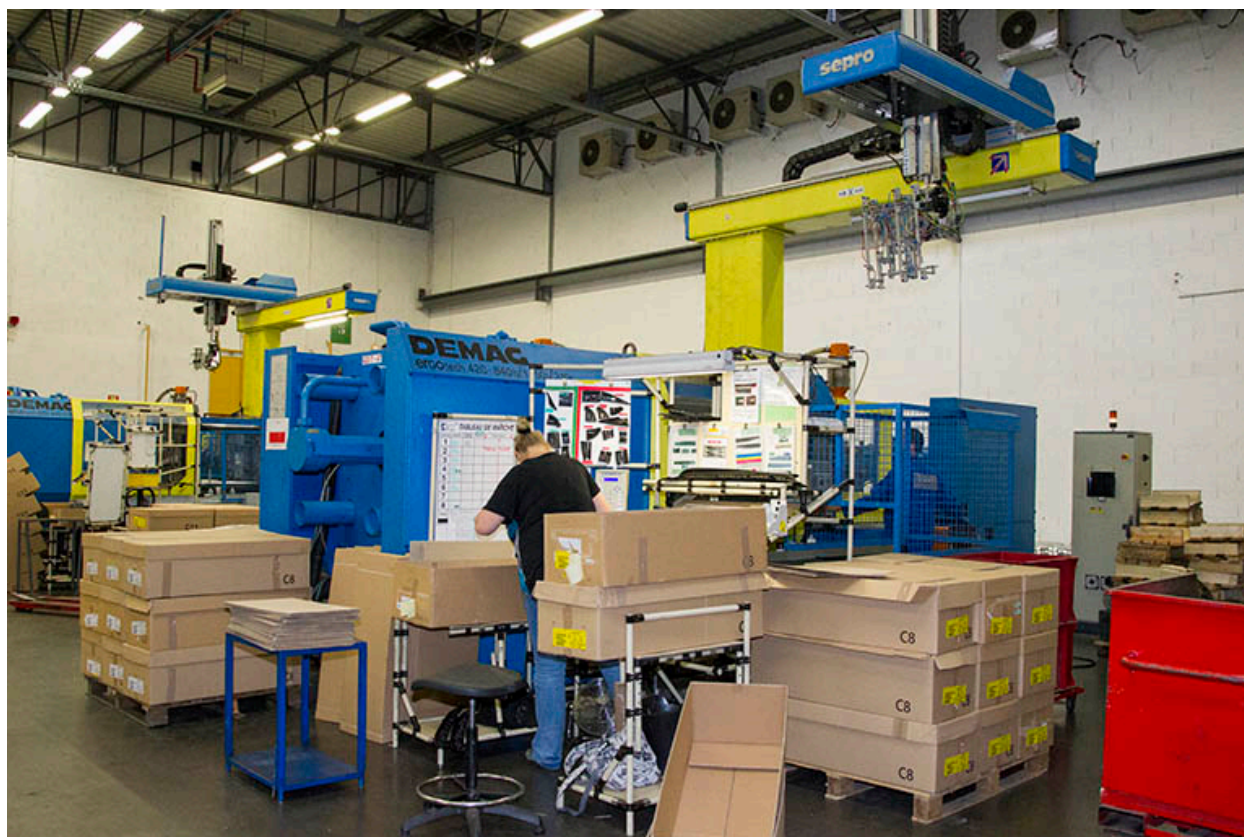
Site récent : presse dans un atelier d'injection plastique.
