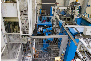
Site ancien : machine de l'atelier d'injection zamak. Phot. Yves Sancey IVR43_20132502458NUC2A
