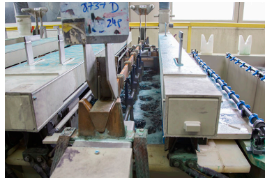
Site ancien : détail de la chaîne de chromage. Phot. Yves Sancey IVR43_20132502459NUC2A
