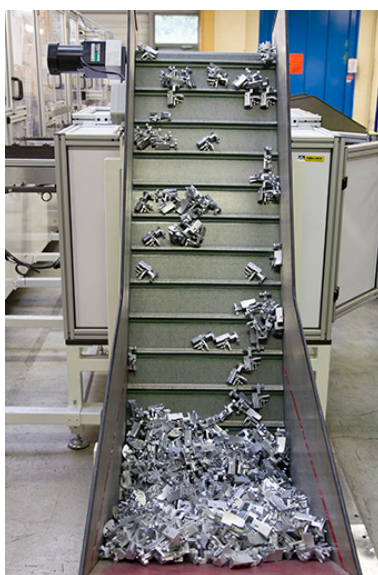
Site récent : convoyeur de l'atelier d'injection zamak. Phot. Yves Sancey IVR43_20132502474NUC2A
