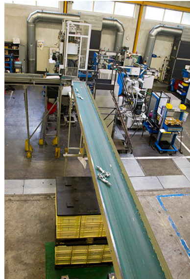
Site ancien : convoyeur à bande de l'atelier d'injection zamak. Phot. Yves Sancey IVR43_20132502456NUC2A
