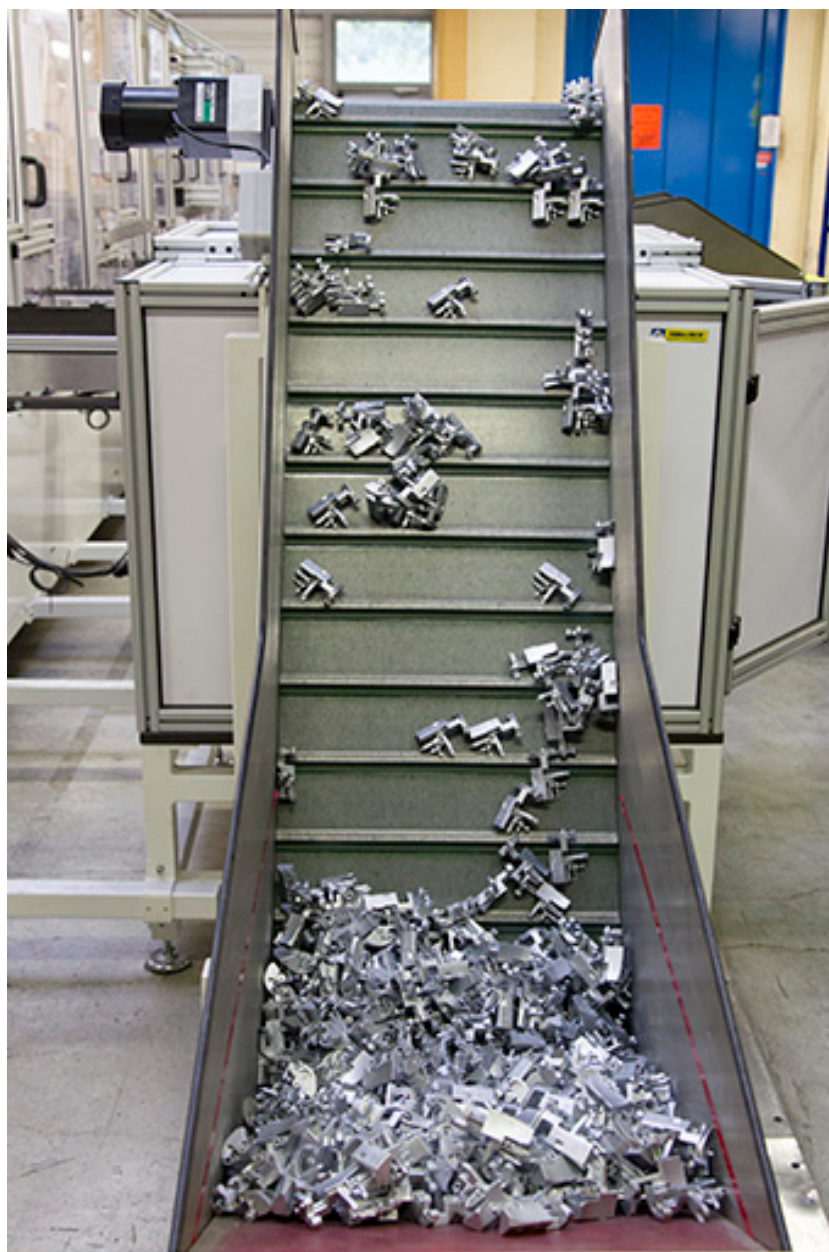
Site récent : convoyeur de l'atelier d'injection zamak.
