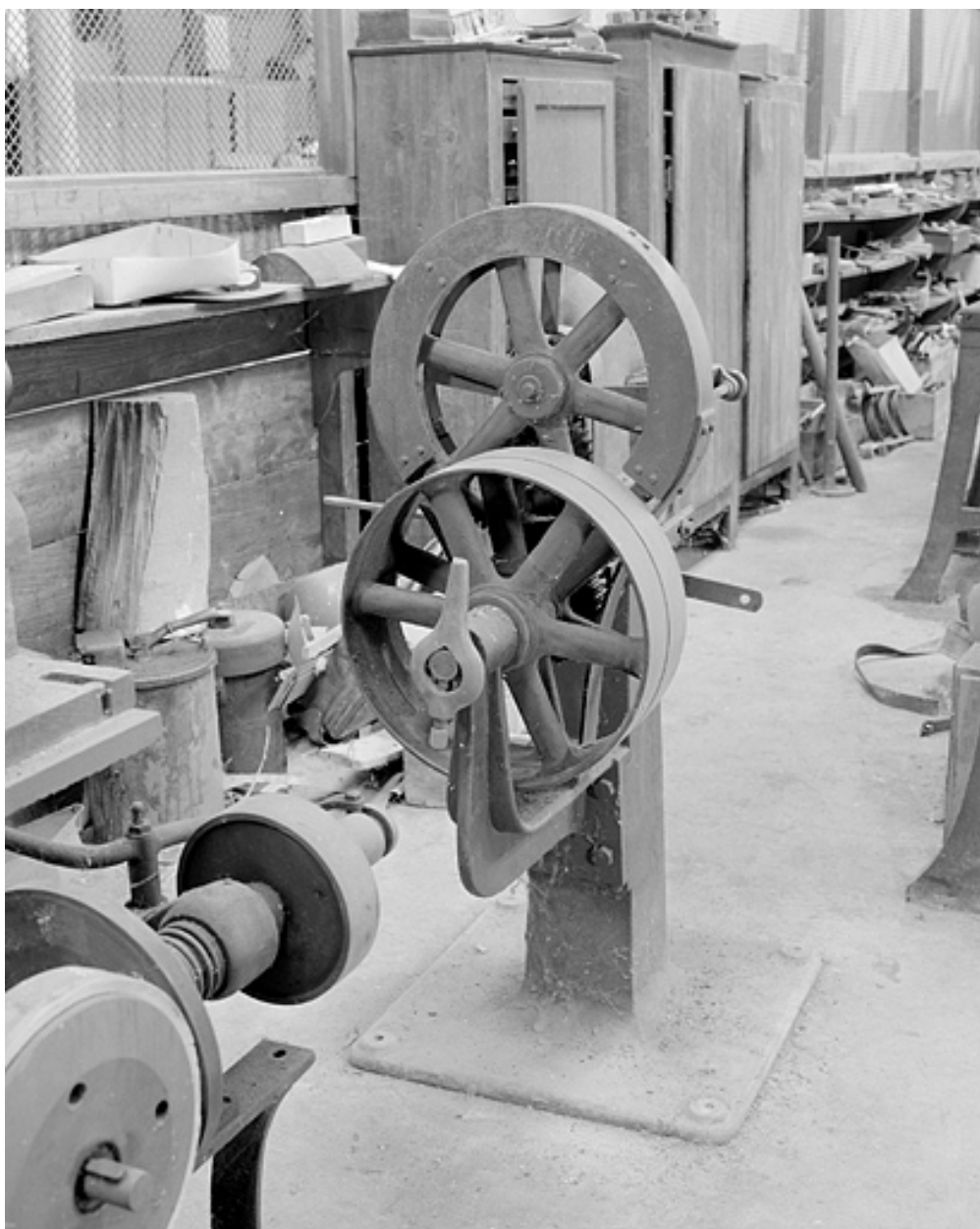
Détail des poulies de transmission.
