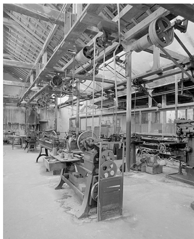
Atelier de mécanique. Distribution par courroies verticales. Phot. Yves Sancey IVR43_20022500887X
