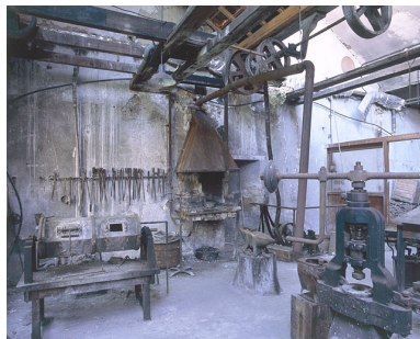
Atelier de mécanique. Départ de la transmission et poulie maîtresse (au fond). Phot. Yves Sancey IVR43_20022500829XA
