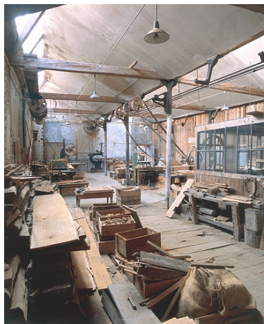
Vue d'ensemble de l'atelier de menuiserie. Axe principal à droite et axe secondaire contre le mur à gauche. Phot. Yves Sancey IVR43_20022500731XA
