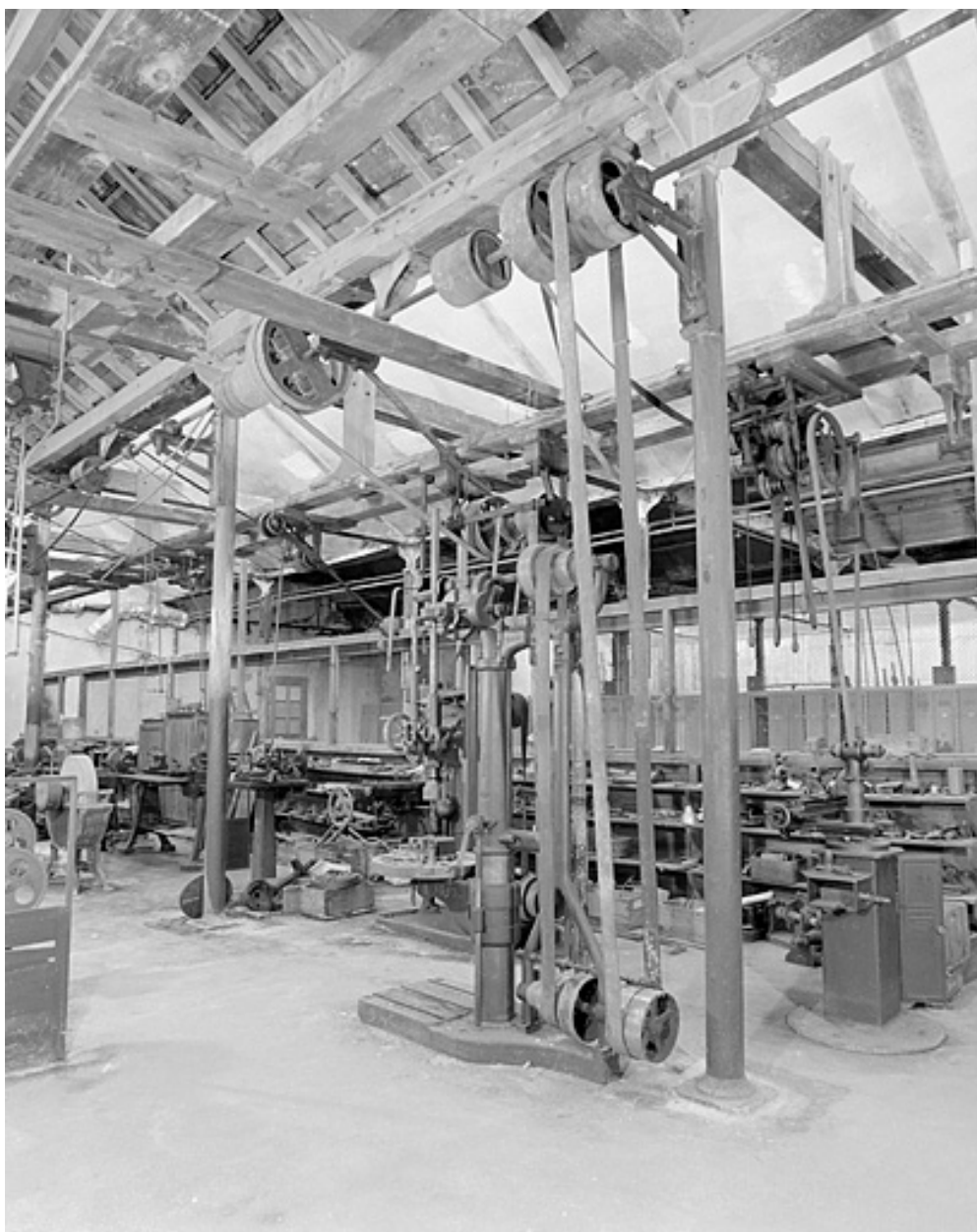
Atelier de mécanique. Transmission par courroies verticales de la perceuse à colonne.
