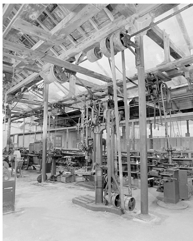
Atelier de mécanique. Transmission par courroies verticales de la perceuse à colonne. Phot. Yves Sancey IVR43_20022500900X
