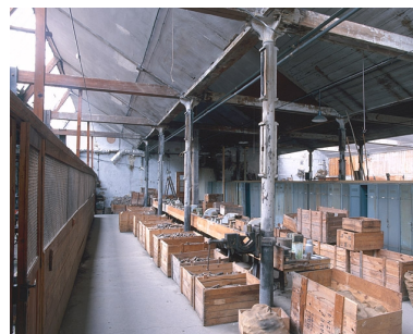
Partie est de l'atelier de fabrication de pipes. Les poteaux de fonte conservent la trace des consoles qui soutenaient les arbres de transmission.
