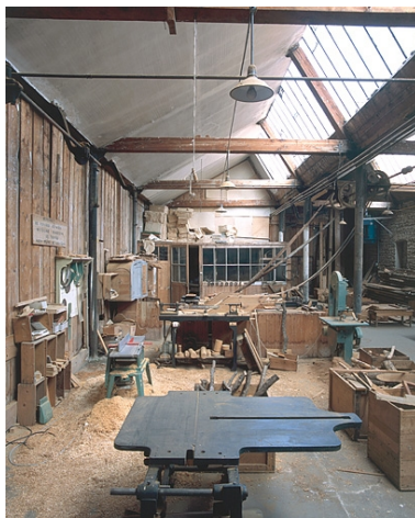
Atelier de menuiserie. Distribution par courroies obliques des machines situées au sud de l'atelier. Phot. Yves Sancey IVR43_20022500733XA
