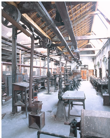
Atelier de mécanique. Vue de l'arbre de transmission distribuant l'énergie aux machines. Phot. Yves Sancey IVR43_20022500813XA
