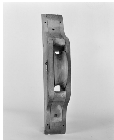
Accessoire des cintres, 1988 : poulie simple. Phot. Jean-Luc Duthu IVR26_19882100595X
