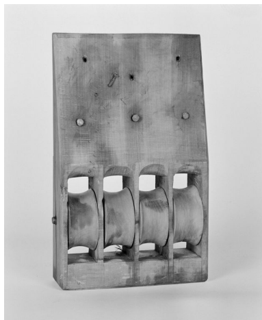
Accessoire des cintres, 1988 : poulie quadruple. Phot. Jean-Luc Duthu IVR26_19882100593X
