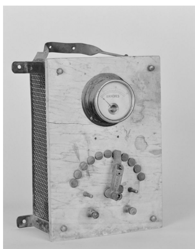
Accessoire d'éclairage, 1988 : rhéostat (transformateur). Phot. Jean-Luc Duthu IVR26_19882100590X
