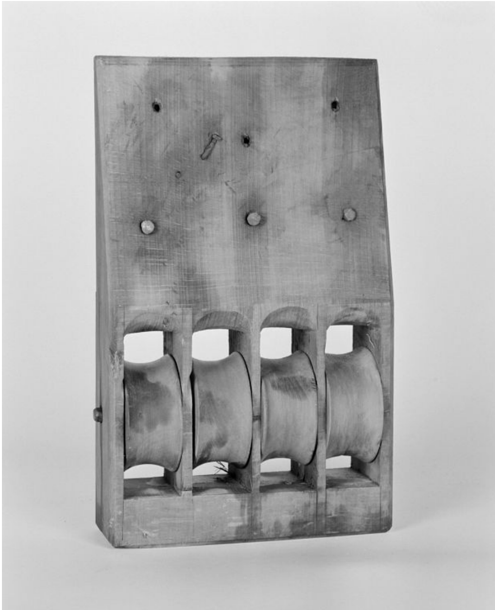
Accessoire des cintres, 1988 : poulie quadruple.
