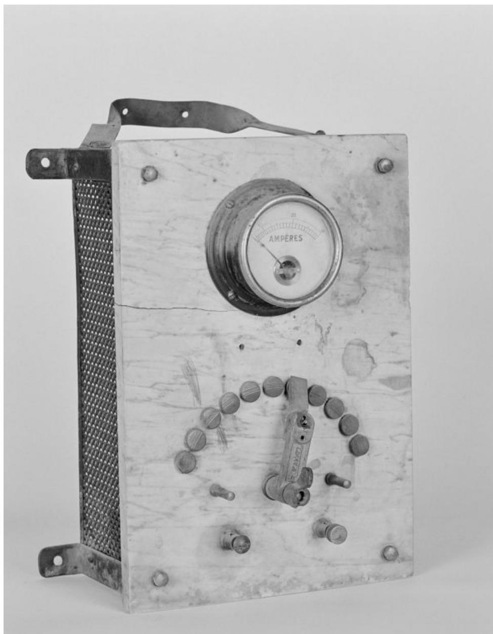
Accessoire d'éclairage, 1988 : rhéostat (transformateur).
