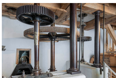
Rez-de-chaussée. Détail des transmissions et des colonnes du beffroi. Phot. Jérôme Mongreville IVR43_20162500284NUC4A
