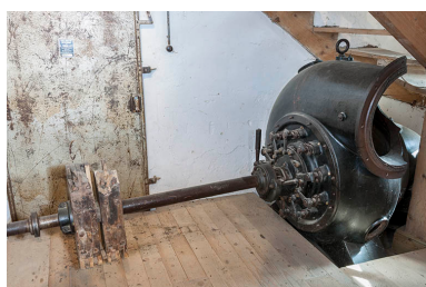
Fragment de la turbine de la scierie (déplacée). Phot. Jérôme Mongreville IVR43_20162500282NUC4A
