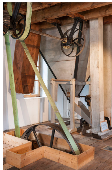
Deuxième étage. Détail du système de transmission par poulies et courroies. Phot. Jérôme Mongreville IVR43_20162500274NUC4A
