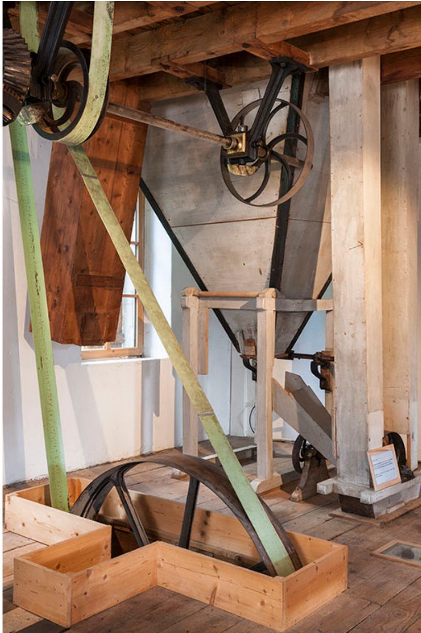
Deuxième étage. Détail du système de transmission par poulies et courroies.
