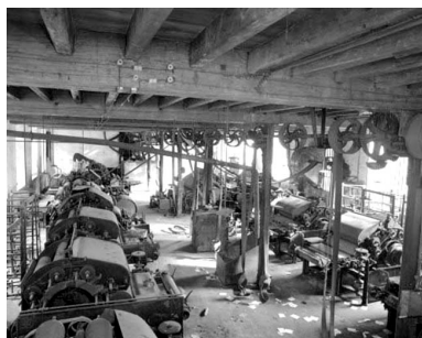
Vue d'ensemble des cardes. Phot. Yves Sancey IVR43_19943901547X
