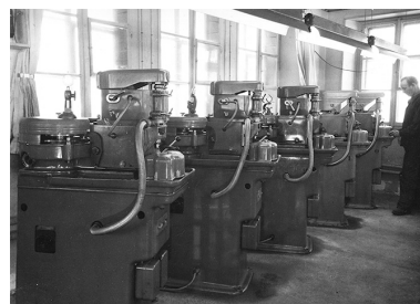
Atelier de fraisage (groupe de contourneuses Crouzet à 12 profondeurs) - fabrication française, vers 1950. IVR43_20182500827NUC4A
