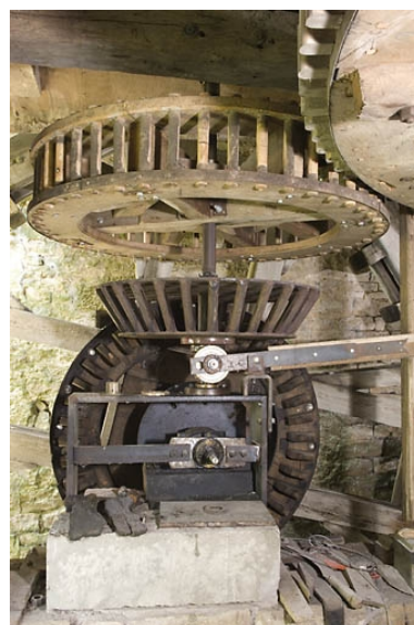
Détail des éléments de transmission (roues dentées et lanternes). Phot. Jérôme Mongreville IVR43_20087000977NUC2A
