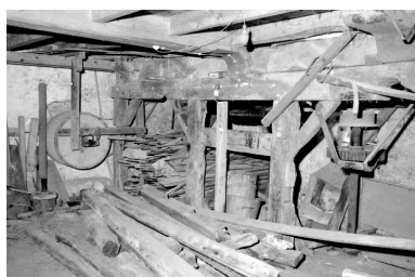
Tonneau de polissage et transmission (2e étage de soubassement). Phot. Laurent Poupard IVR43_19913901267Z
