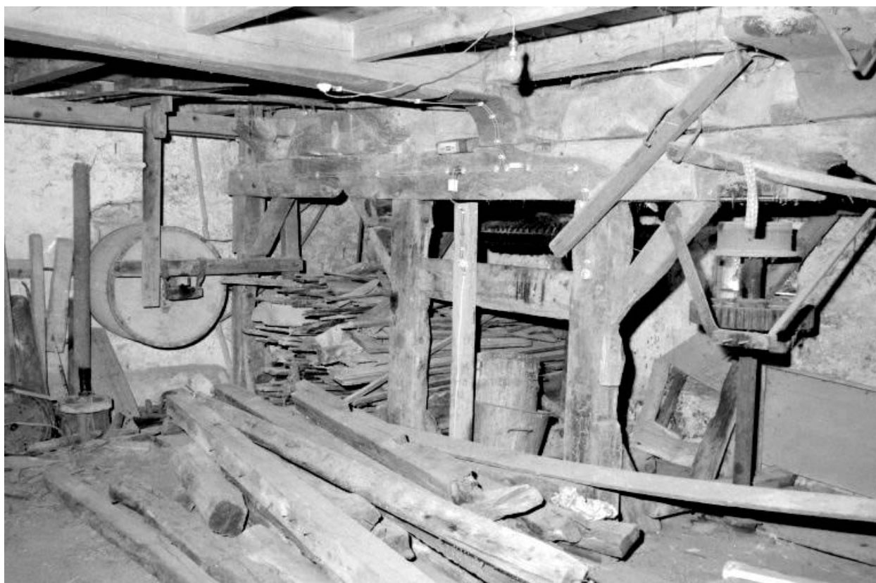
Tonneau de polissage et transmission (2e étage de soubassement).
