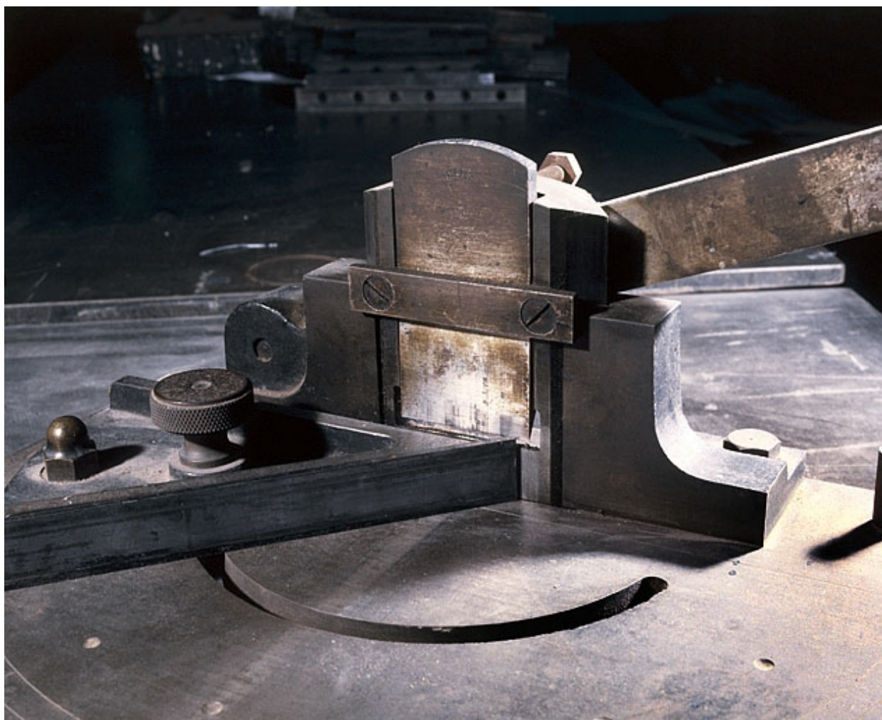
Coupe oblique d'un filet avec le "couteau-rabot". Le filet est appuyé contre le guide triangulaire mobile, à gauche.
