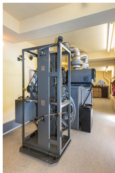
Ancienne cabine de projectionniste (enrouleur de films Cinemeccanica et projecteur Strong Simplex 35 Millenium). Phot. Pierre-Marie Barbe-Richaud IVR26_20238900411NUC4A
