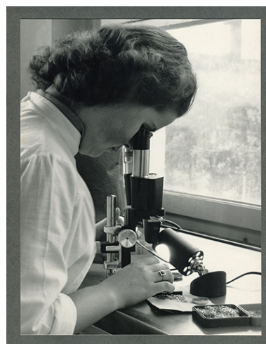
Ouvrière au travail : contrôle de balanciers, années 1960. IVR43_20182500798NUC4A
