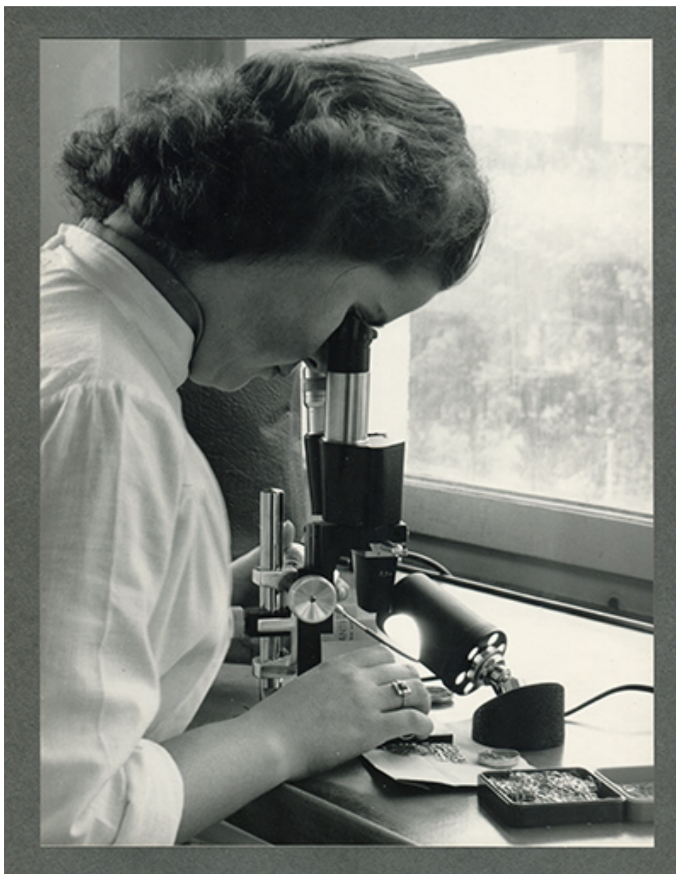
Ouvrière au travail : contrôle de balanciers, années 1960.
