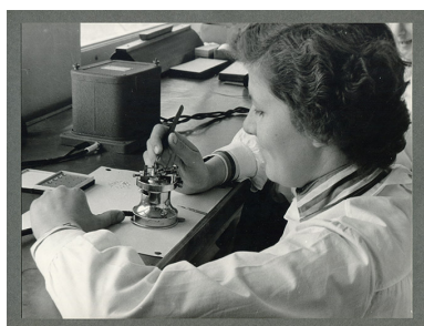
Ouvrière au travail : réglage du balancier-spiral, années 1960. IVR43_20182500796NUC4A
