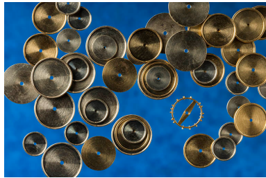
Exemple de composants fabriqués à l'usine : balanciers de montre en cours d'usinage (rondelles).
