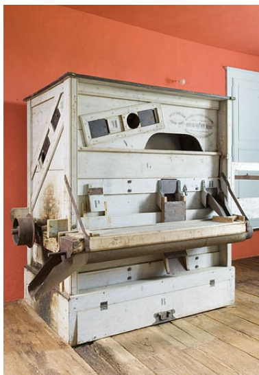
Nettoyeur-dépoussiéreur à grains. Phot. Jérôme Mongreville IVR43_20097000513NUC2A
