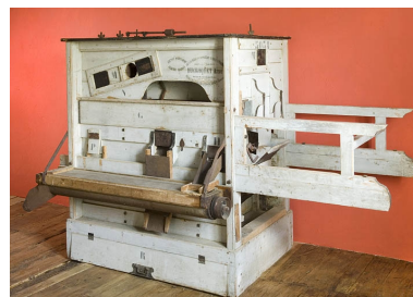
Nettoyeur-dépoussiéreur à grains. Vue de trois quarts. Phot. Jérôme Mongreville IVR43_20097000514NUC2A
