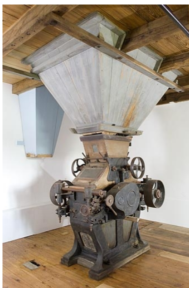
Appareil à cylindres Goulut-Borne. Vue de trois quarts. Phot. Jérôme Mongreville IVR43_20097000509NUC2A
