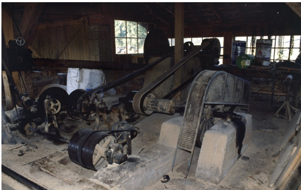
Système d'entraînement de la scie par poulies, courroies, bielle et manivelle.
