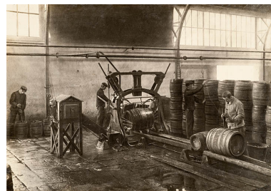
Visite des fûts et lavage extérieur. Phot. Jérôme Mongreville IVR43_20132500478NUC4A
