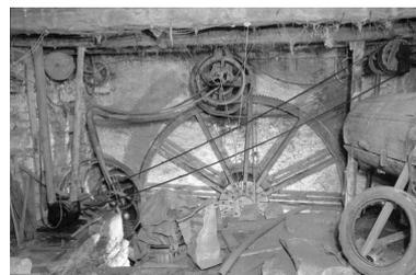
Intérieur de la salle des machines : moteur électrique, transmission de la roue hydraulique et tonneau de polissage.
