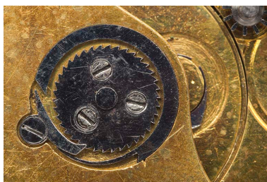
Détail de la face côté cadran : cliquet et roue d'encliquetage du barillet. Phot. Sonia Dourlot IVR43_20152500259NUC4A
