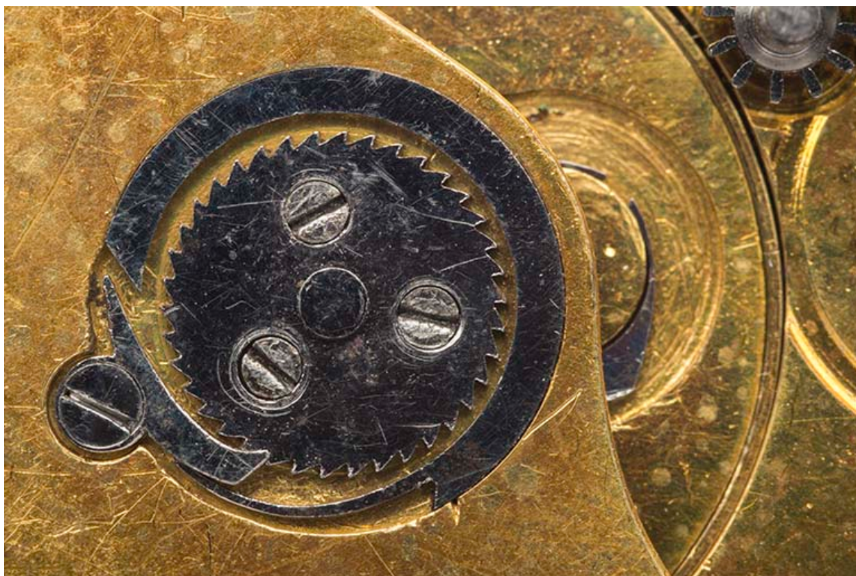
Détail de la face côté cadran : cliquet et roue d'encliquetage du barillet.
