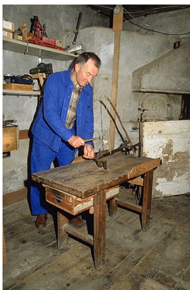
Poinçonnage d'une lame. Phot. Yves Sancey IVR43_19913900788ZA
