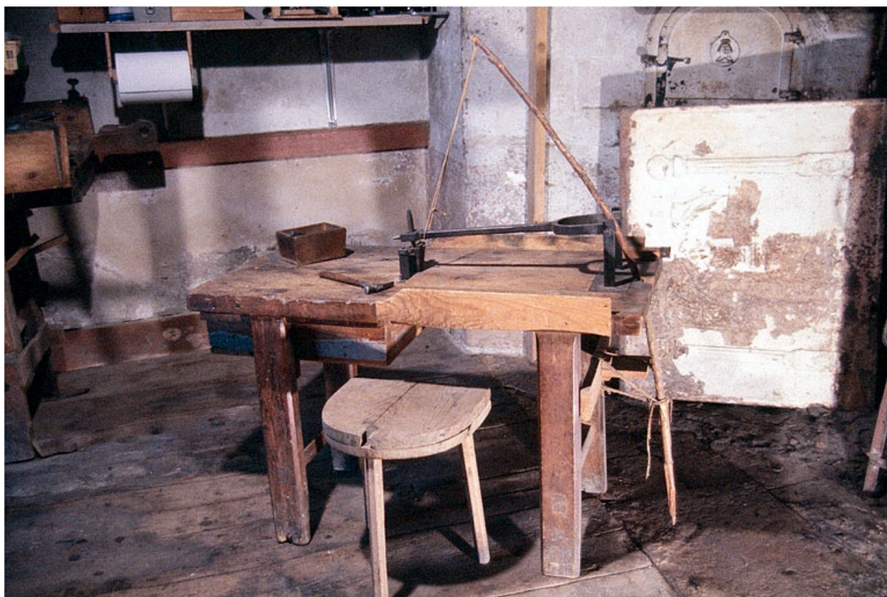
Banc à poinçonner.
