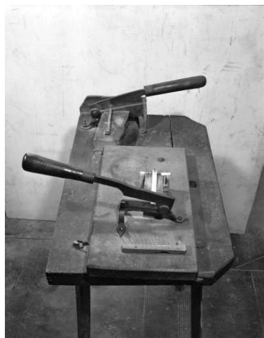
Vue plongeante sur le banc à couper la première lame. Phot. Yves Sancey IVR43_19913900758X
