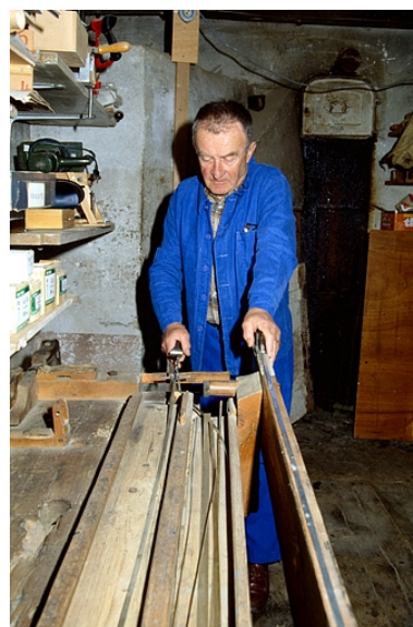
Ebarbage d'une bande de métal (sur le banc à racler).
