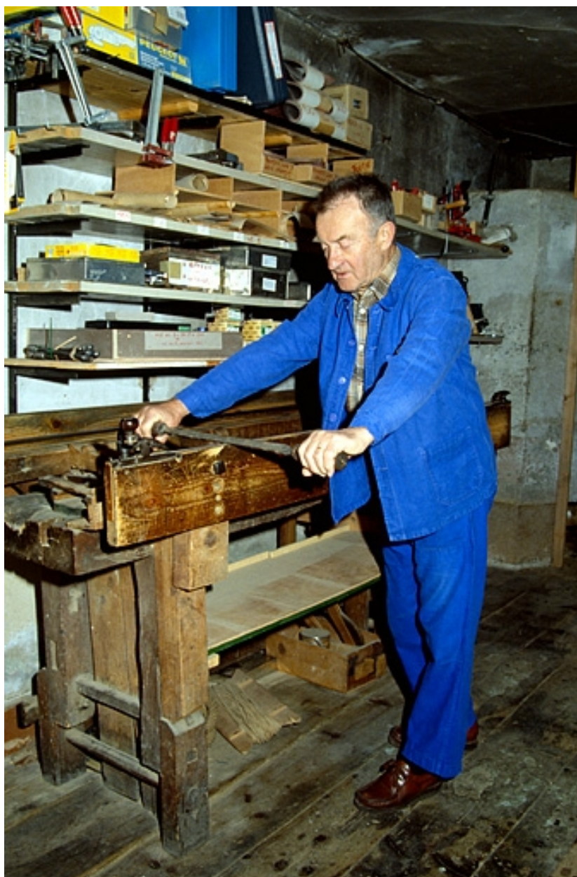
Décapage d'une bande de métal (sur le banc à racler).
