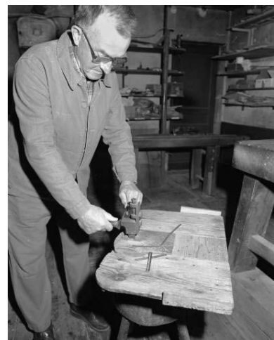
Mise au gabarit du "clou". Phot. Yves Sancey IVR43_19913900784X
