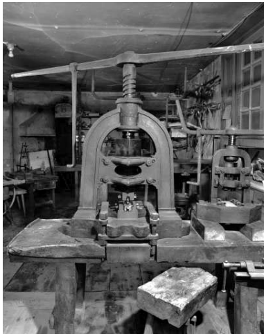
Détail de la grande presse à vis à balancier et de son poinçon. Phot. Yves Sancey IVR43_19913900755X
