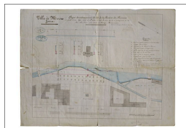
Projet de redressement du lit de la rivière de Bienne [...] : dessin (plume, lavis), 30 avril 1860, échelle 1:500. Phot. Yves Sancey, Phot. Vital Ponard IVR43_20103900090NUC2A
