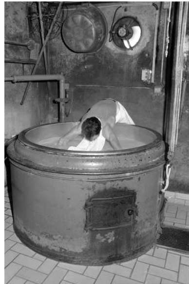
Fabrication du comté : ramassage du caillé dans la toile. Phot. Laurent Poupard IVR43_19903900549Z
