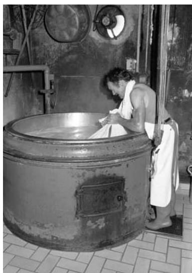
Fabrication du comté : fermeture de la toile. Phot. Laurent Poupard IVR43_19903900550Z
