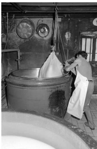
Fabrication du comté : sortie du caillé hors de la cuve. Phot. Laurent Poupard IVR43_19903900551Z
