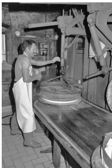
Fabrication du comté : serrage de la presse. Phot. Laurent Poupard IVR43_19903900560Z
