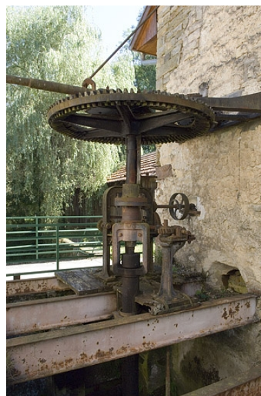
Turbine hydraulique. Partie supérieure de la transmission. Phot. Jérôme Mongreville IVR43_20067000605NUCA
