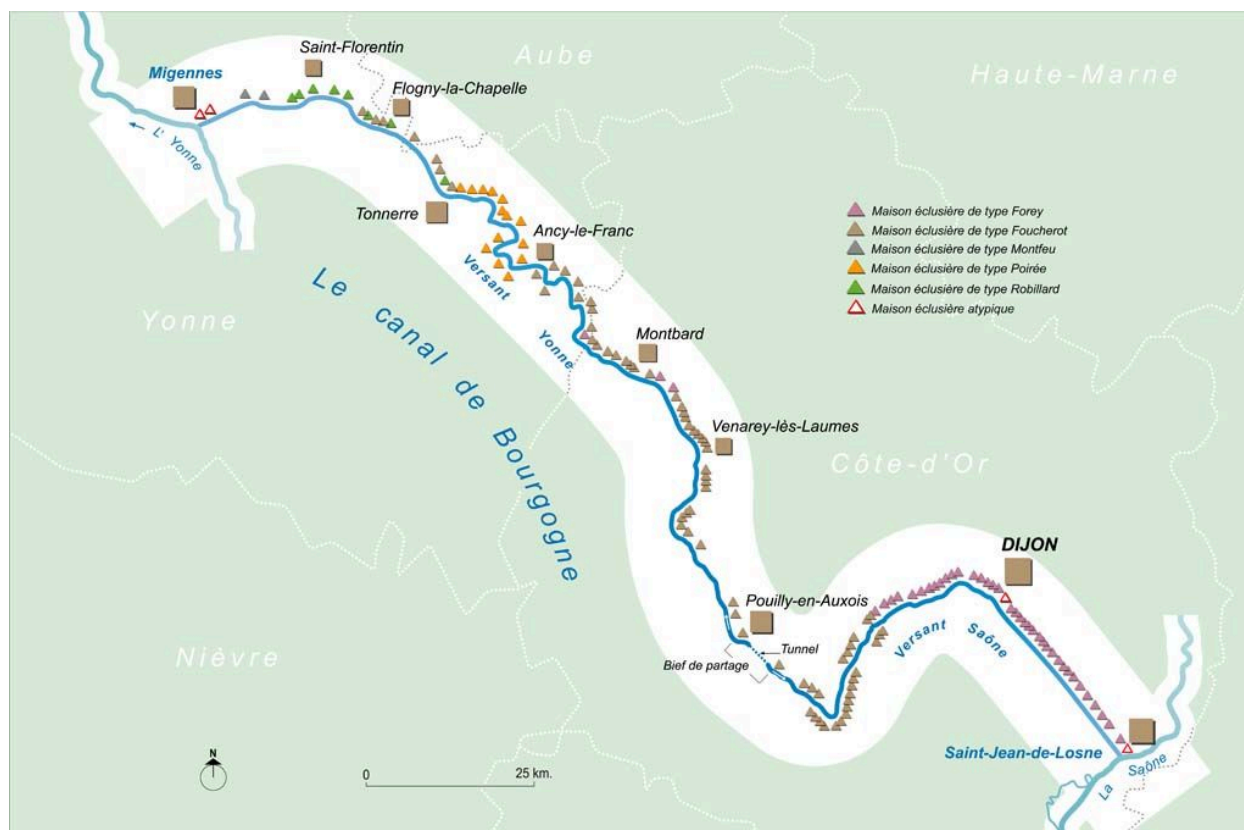
Carte générale schématique du canal de Bourgogne avec la répartition des différents types de maisons éclusières.
