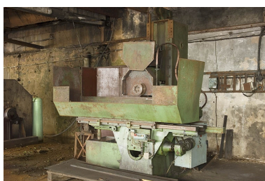
Rectifieuse de lames de scie, dite rectifieuse plane. Phot. Jérôme Mongreville IVR43_20067000443NUCA
