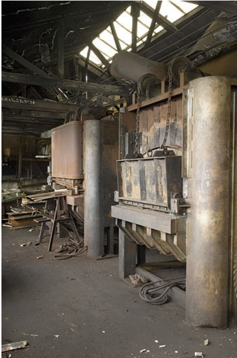
Fours rectangulaires CFI (Montreuil-sous-Bois).
