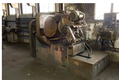
Rectifieuse de lames de scie, dite machine à planer Engeländer et Beyer (Remscheid). Phot. Jérôme Mongreville IVR43_20067000439NUCA
