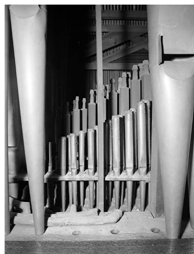
Tuyauterie du clavier du grand orgue à travers la montre, vue de face. Phot. Jérôme Mongreville IVR43_19853900387X
