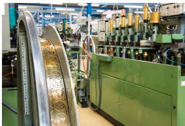
Atelier d'usinage : bande de laiton usinée.
