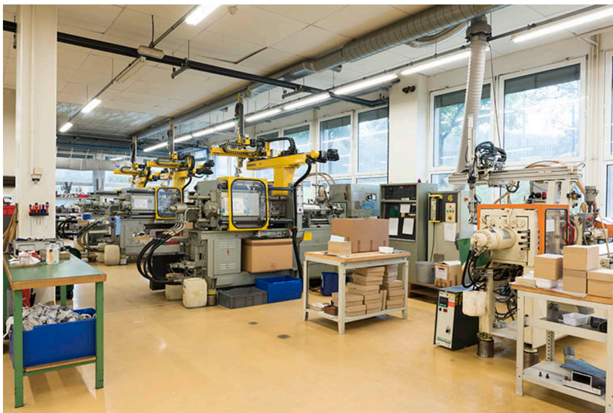
Atelier d'injection : les anciennes presses.
