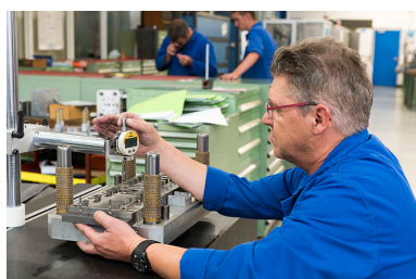
Atelier de fabrication de l'outillage : contrôles sur une étau progressive.
