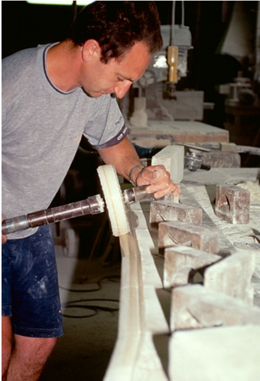
Polissage d'un limon d'escalier.
