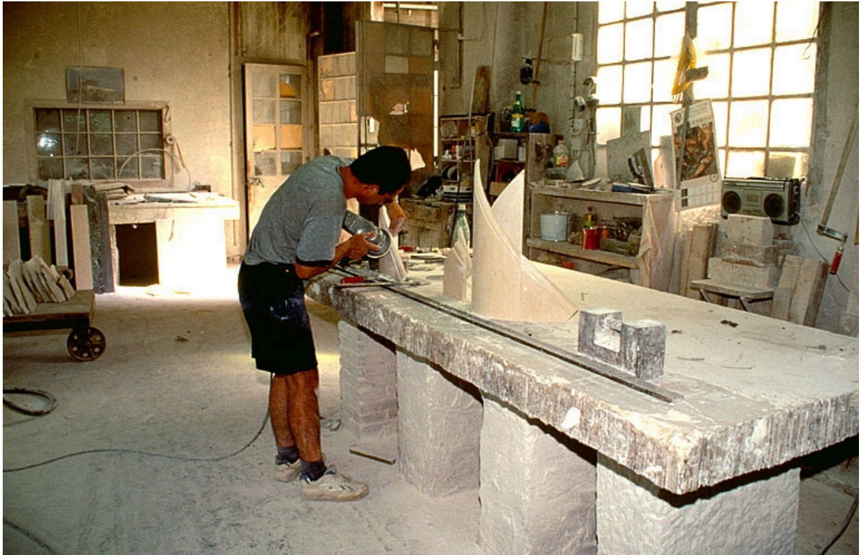
Polissage d'un limon d'escalier.
