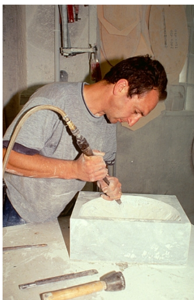
Creusage d'un lavabo. Phot. Yves Sancey IVR43_19973901791ZA
