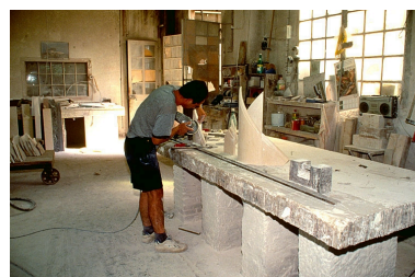
Polissage d'un limon d'escalier. Phot. Yves Sancey IVR43_19973901782ZA
