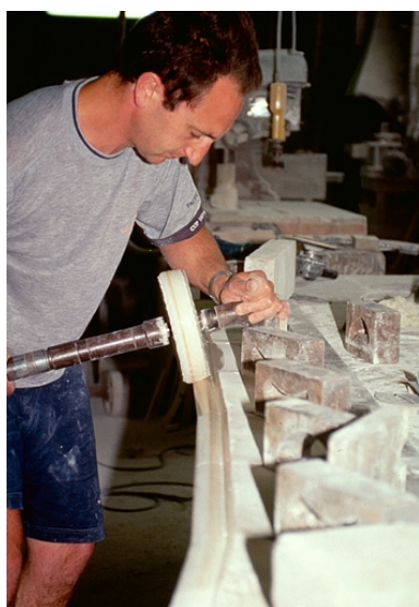
Polissage d'un limon d'escalier. Phot. Yves Sancey IVR43_19973901788ZA
