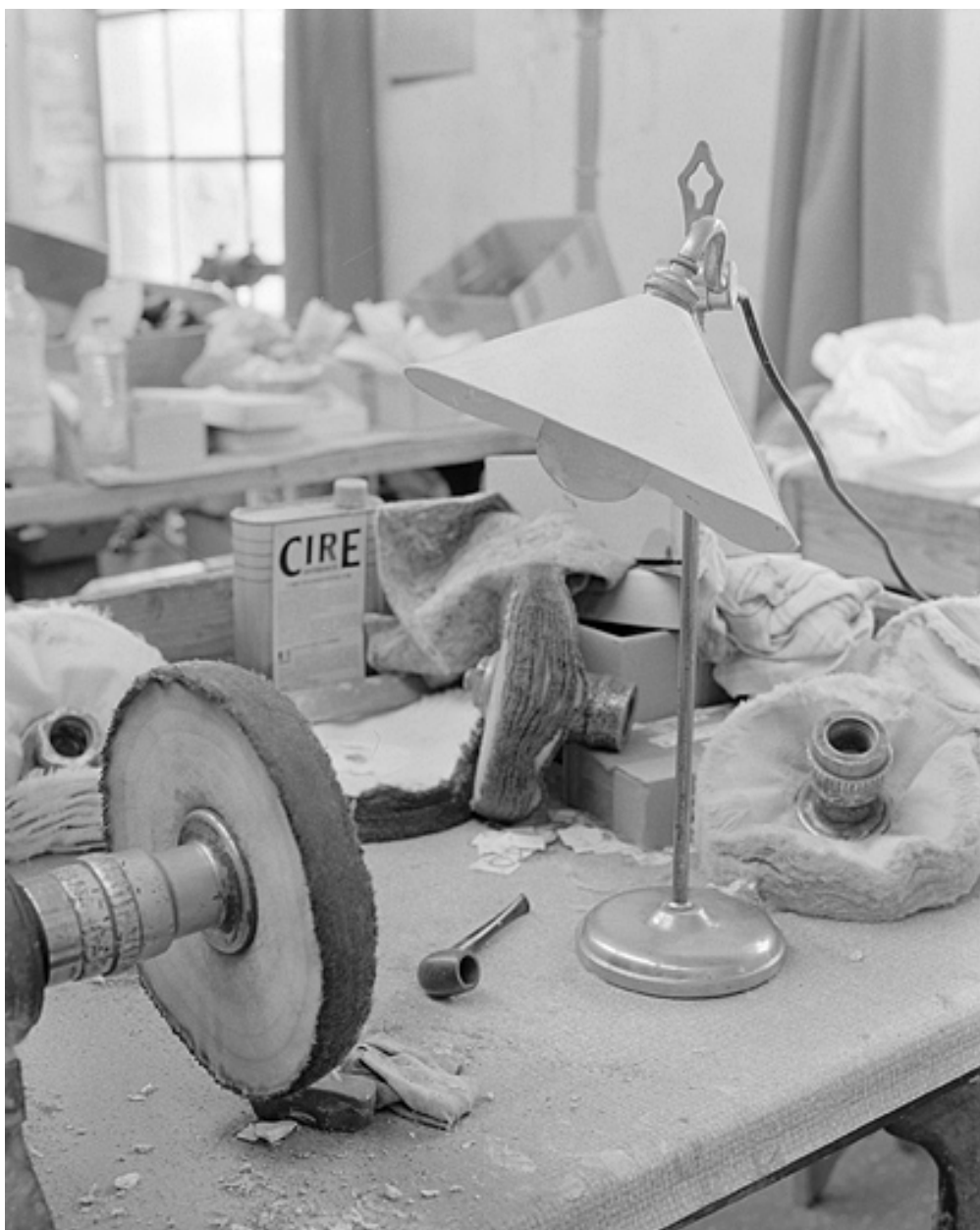
Trois mandrins posés sur un établi (atelier de finissage).
