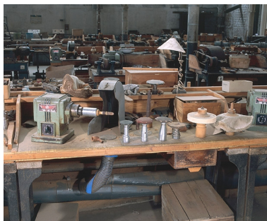
Vue d'ensemble d'un polissoir, de ses différents mandrins et de la bouche d'aspiration des poussières (atelier principal). Phot. Jérôme Mongreville IVR43_20022500510XA
