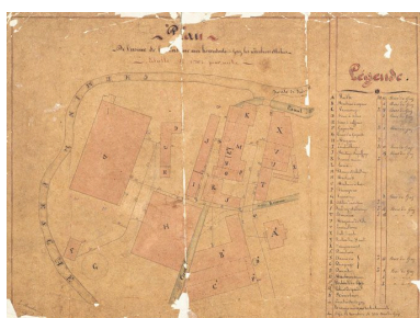
Plan de l'usine de la Casserie avec les conduites de gaz, les réverbères et les becs. Plan, calque collé, encre, lavis, échelle 1/500, s.d. [fin 19e siècle]. Phot. Jérôme Mongreville, Autr. IVR43_20122501185NUC4A
