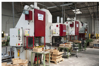
Atelier d'emboutissage. Batterie de presses. Phot. Jérôme Mongreville IVR43_20112502312NUC4A
