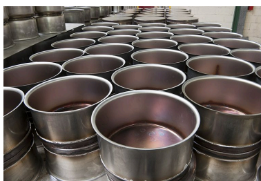
Stockage des pièces après brasage. Phot. Jérôme Mongreville IVR43_20112502318NUC4A
