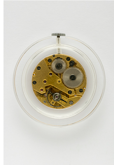
Mouvement Parrenin HP 87 : face côté ponts. Phot. Sonia Dourlot IVR43_20162500703NUC4A
