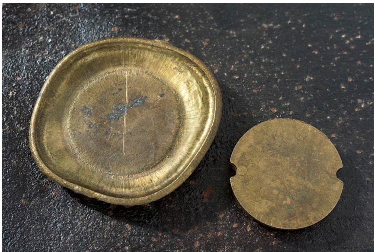
Ebauche obtenue par frappe à chaud (verso).
