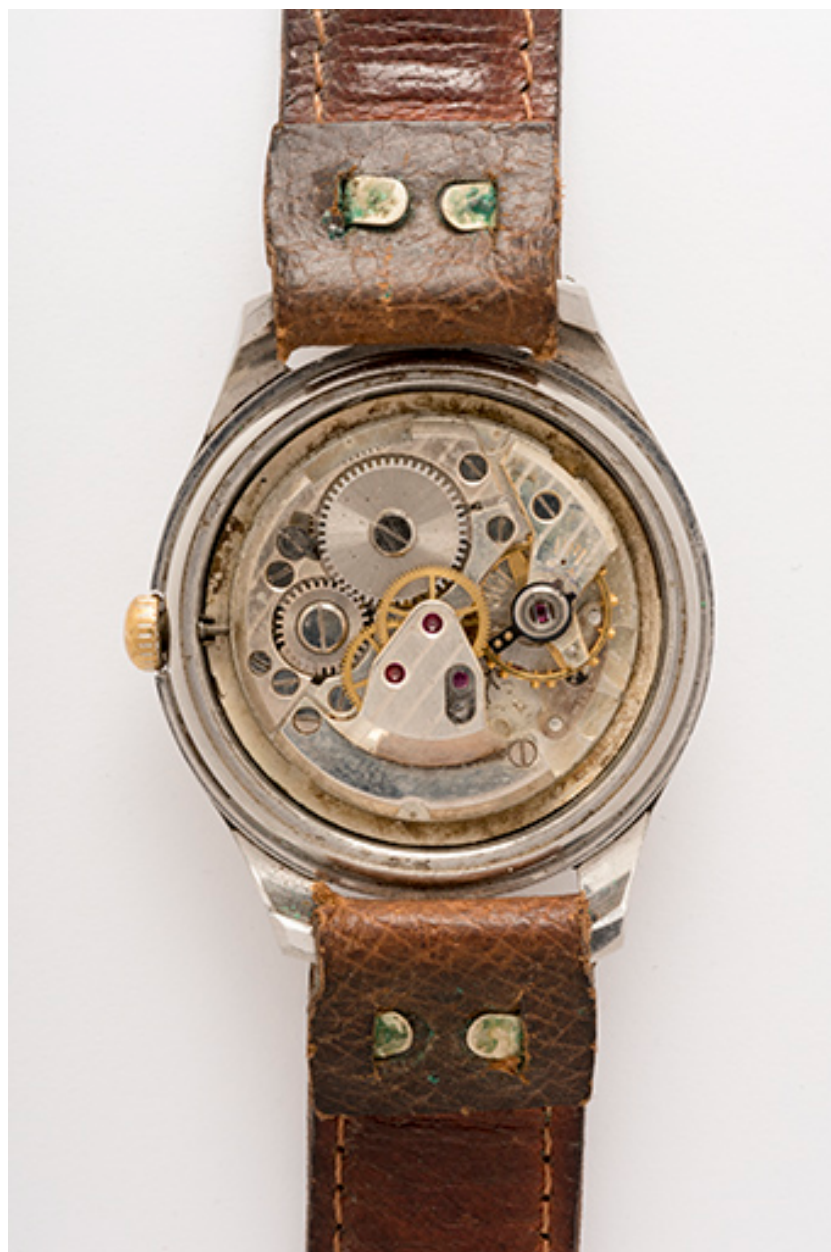
Montre-bracelet mécanique Manufrance : mouvement Parrenin HP 901.
