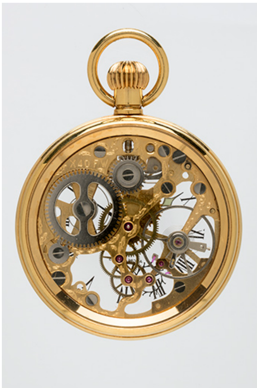
Montre Fabior-Watch utilisant un mouvement Parrenin HP X40 "squelettisé".
