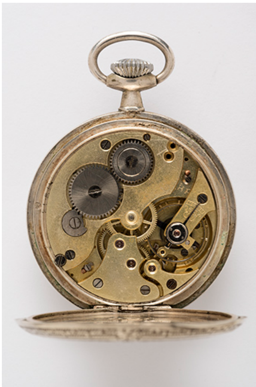
Montre de gousset mécanique des Ets Victor Mougin : mouvement Parrenin HP modèle T.
