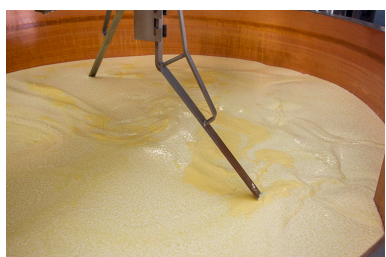
Fabrication : chauffage et brassage du lait. Phot. Sonia Dourlot IVR43_20142500762NUC2A
