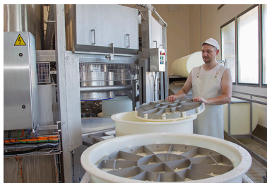
Fabrication : mise en place du couvercle sur le moule à comté. Phot. Sonia Dourlot IVR43_20142500746NUC2A
