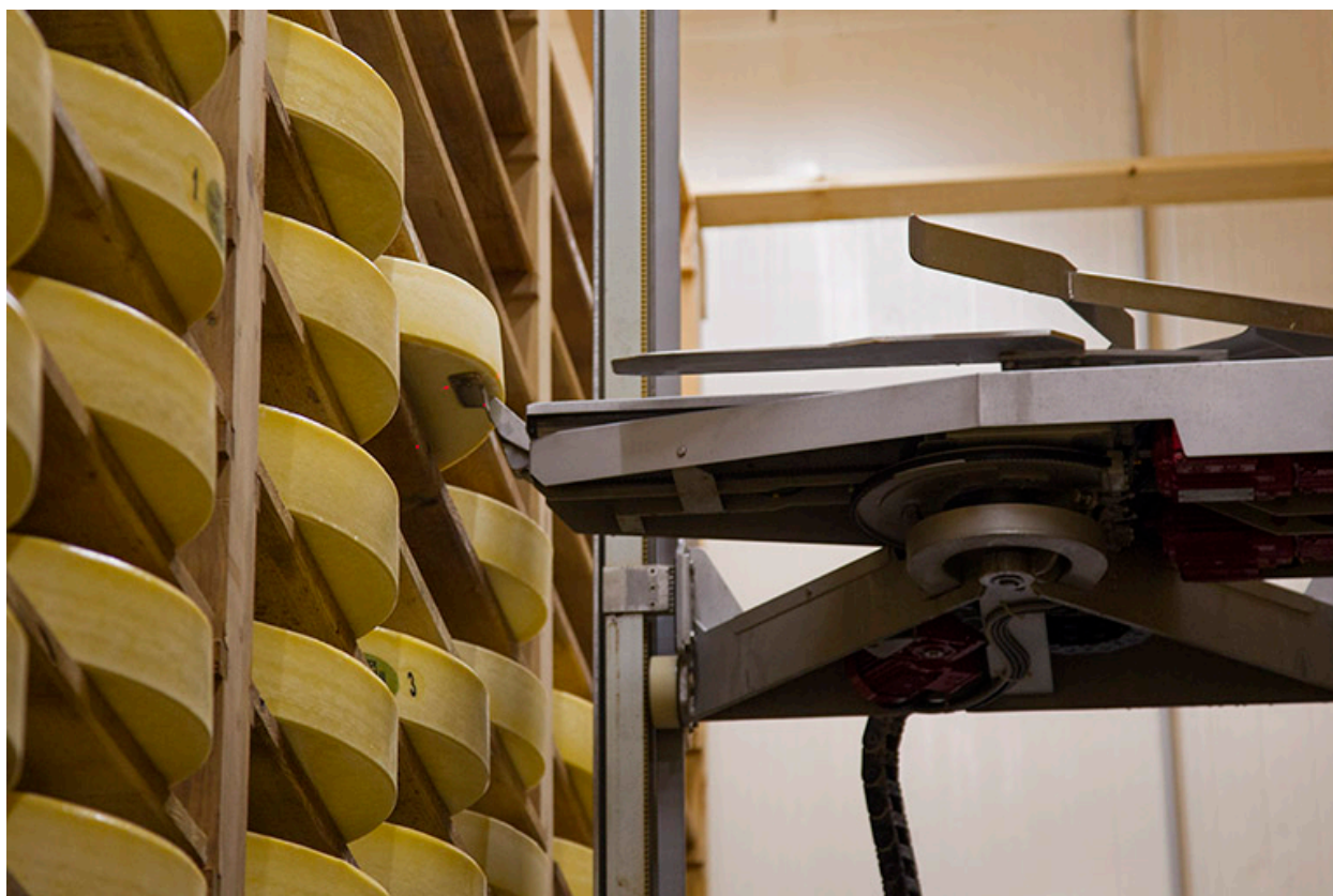
Affinage du comté : robot soulevant une meule.
