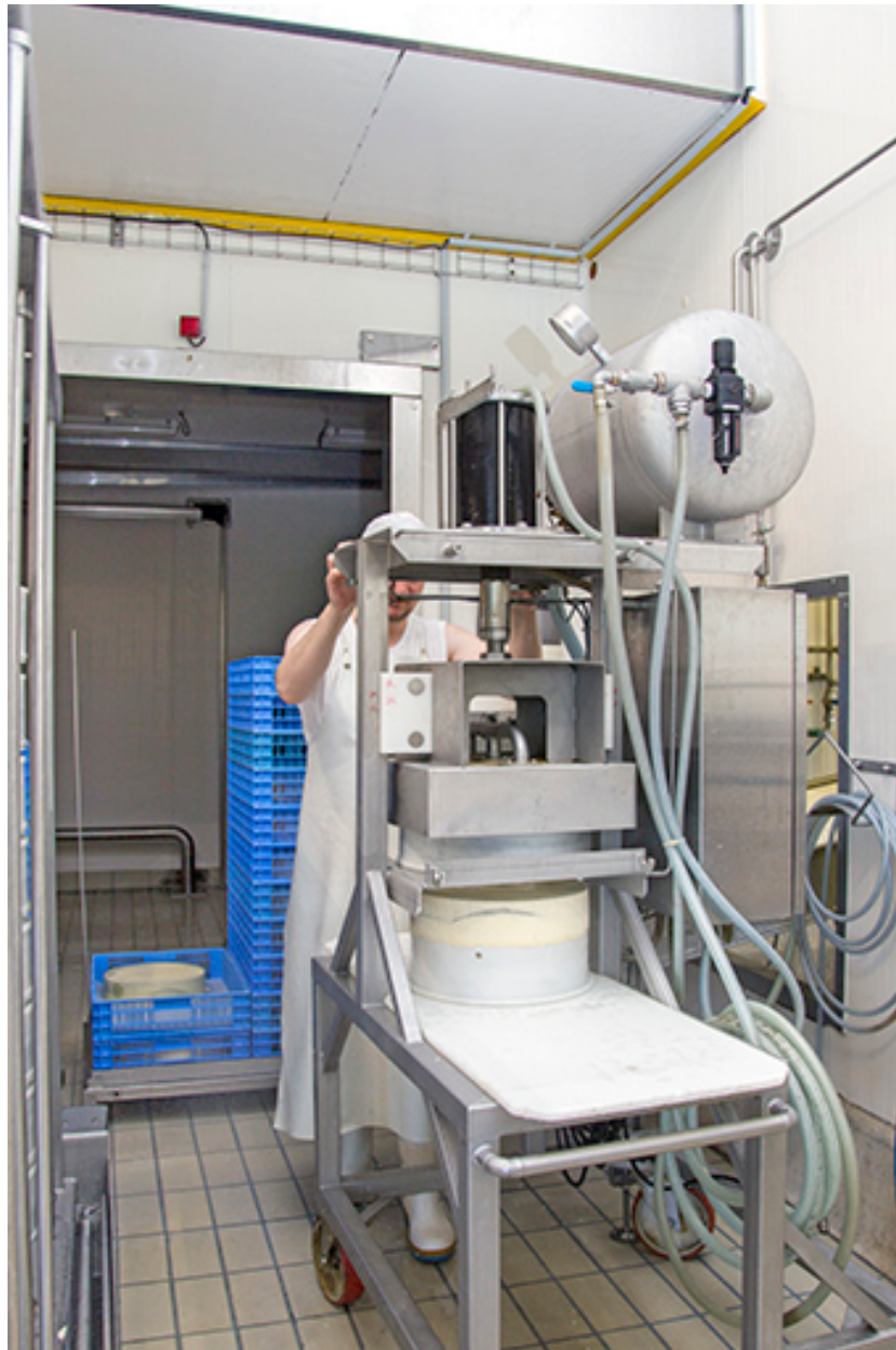
Fabrication : démoulage des comtés.
