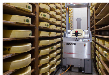
Affinage du comté : le robot de soins (vue rapprochée, avec retournement d'une meule). Phot. Sonia Dourlot IVR43_20142500752NUC2A
