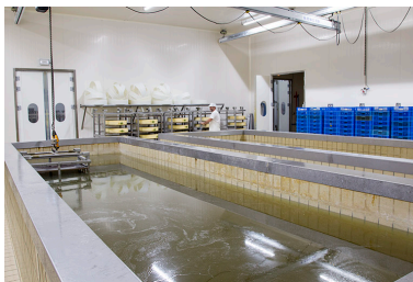
Fabrication : trempage des meules de comté dans le bac à saumure. Phot. Sonia Dourlot IVR43_20142500790NUC2A
