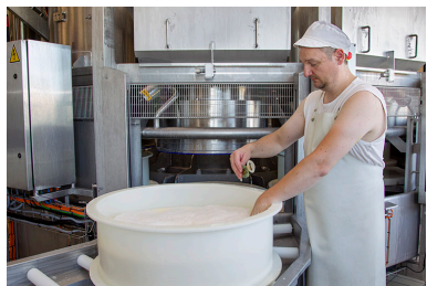
Fabrication : mise en place de la plaque verte (" carte d'identité " de la meule de comté). Phot. Sonia Dourlot IVR43_20142500745NUC2A
