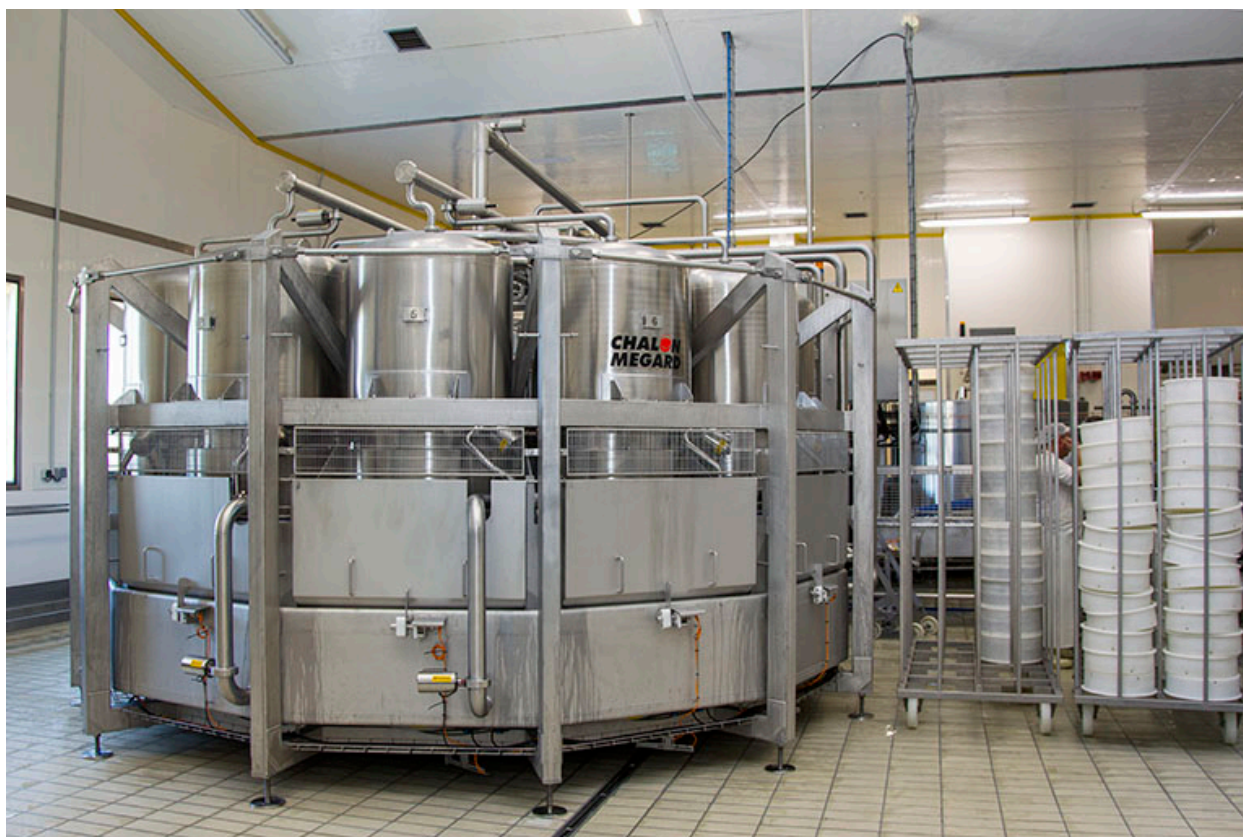
Atelier de fabrication : le soutirage sous vide.
