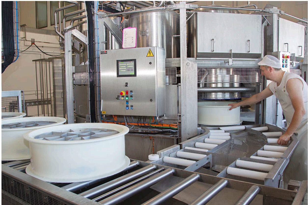
Fabrication : sortie du soutirage sous vide.
