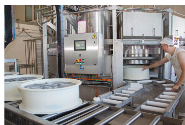
Fabrication : sortie du soutirage sous vide. Phot. Sonia Dourlot IVR43_20142500744NUC2A
