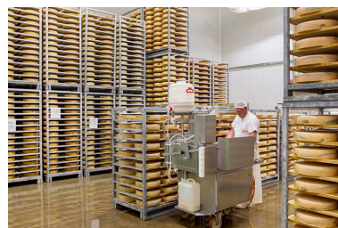
Affinage du morbier : machine de frottage, dans la cave. Phot. Sonia Dourlot IVR43_20142500788NUC2A
