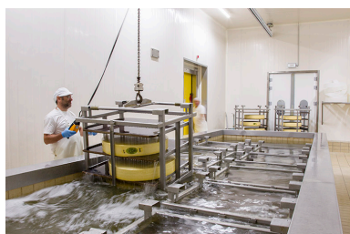
Fabrication : sortie des meules de comté du bac à saumure. Phot. Sonia Dourlot IVR43_20142500796NUC2A
