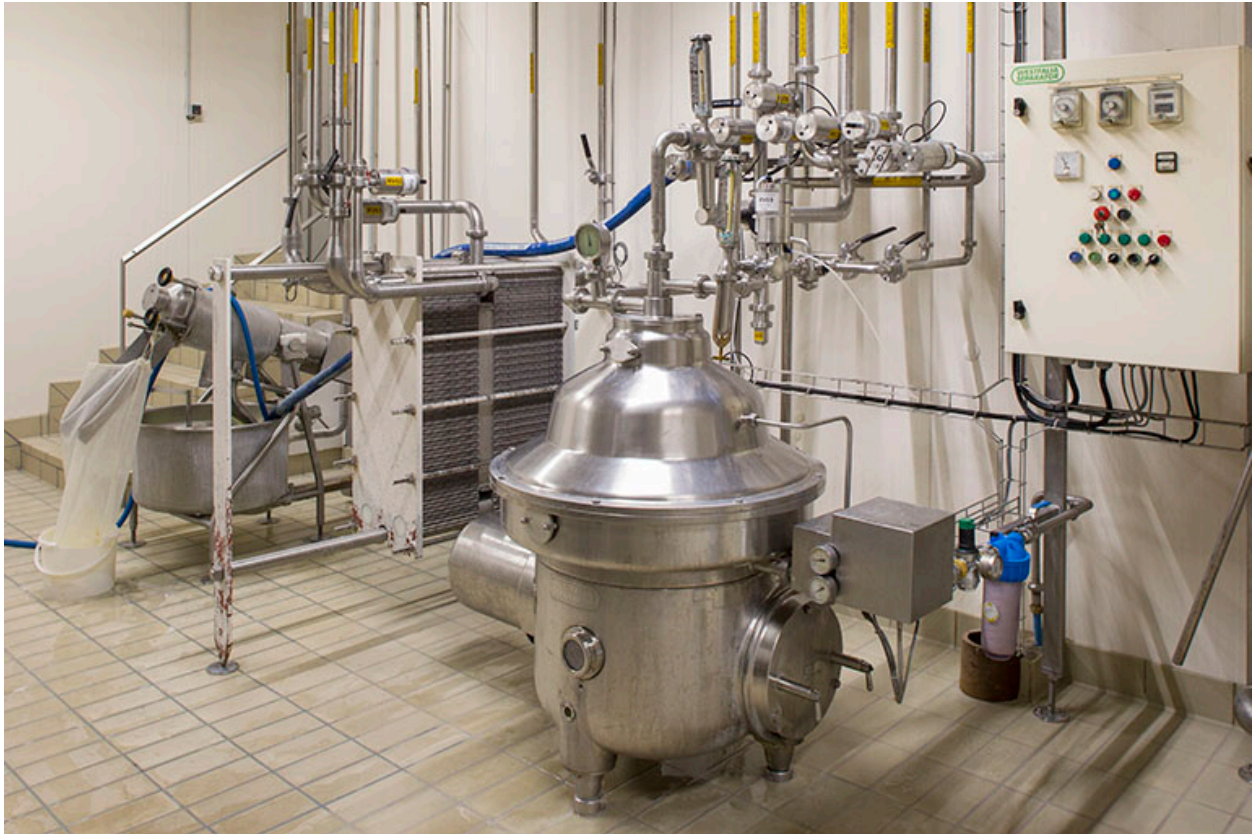
Salle de la station de lavage CIP : débourbeuse (à droite) et filtre à sérum.
