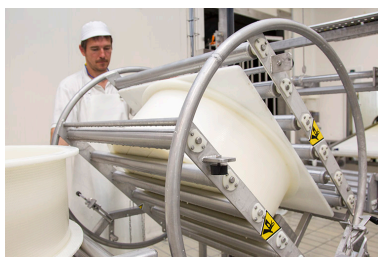
Fabrication du morbier : retournement du moule. Phot. Sonia Dourlot IVR43_20142500767NUC2A
