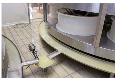
Fabrication : récupération du sérum au pied des presses tournantes. Phot. Sonia Dourlot IVR43_20142500785NUC2A
