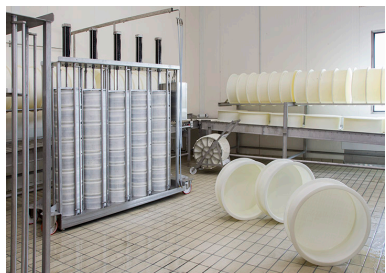
Atelier de fabrication : presses verticales à morbier et moule à comté. Phot. Sonia Dourlot IVR43_20142500776NUC2A
