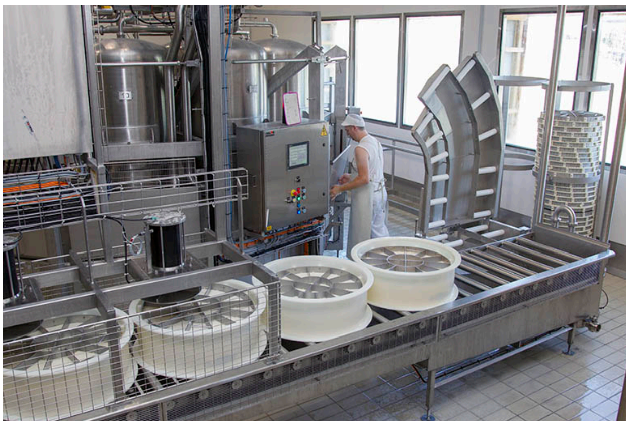
Fabrication : sortie du soutirage sous vide.
