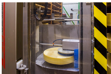
Affinage du comté : frottage de la meule sous un filet de saumure. Phot. Sonia Dourlot IVR43_20142500754NUC2A
