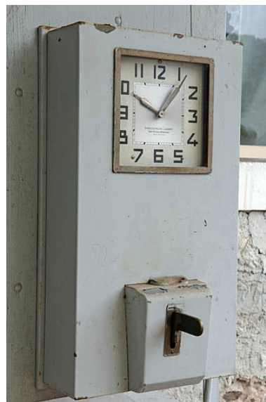
Appareil de pointage. Phot. Jérôme Mongreville IVR43_20057000181NUCA
