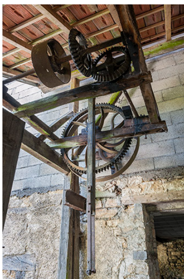
Bâtiment d'eau. Système de transmission des soufflets de la forge (disparus). Phot. Jérôme Mongreville IVR43_20152501253NUC4A
