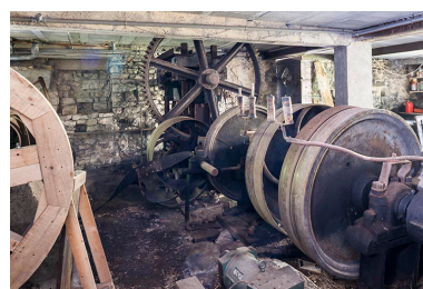
Système d'entraînement des martinets (volants de transmission et d'inertie). Phot. Jérôme Mongreville IVR43_20152501238NUC4A
