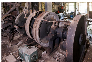
Volants du martinet et arbre à cames. Phot. Jérôme Mongreville IVR43_20152501237NUC4A
