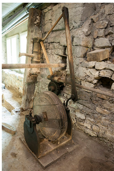
Système d'actionnement de la pompe à eau (bielle-manivelle). Phot. Jérôme Mongreville IVR43_20152501248NUC4A
