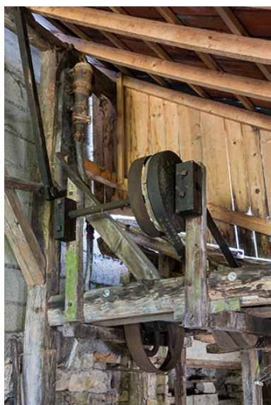
Bâtiment d'eau. Transmission supérieure au droit des turbines. Phot. Jérôme Mongreville IVR43_20152501252NUC4A
