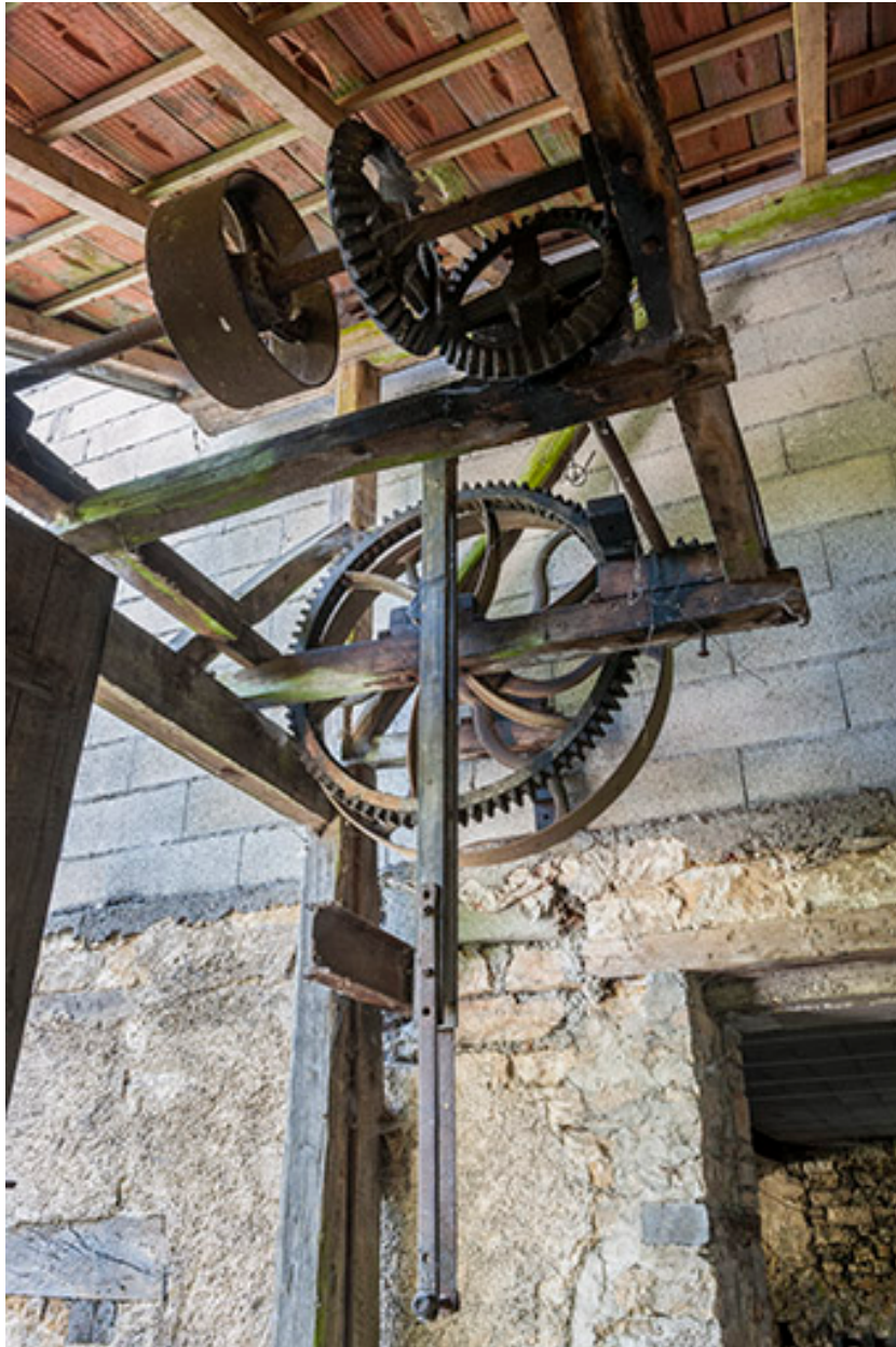
Bâtiment d'eau. Système de transmission des soufflets de la forge (disparus).
