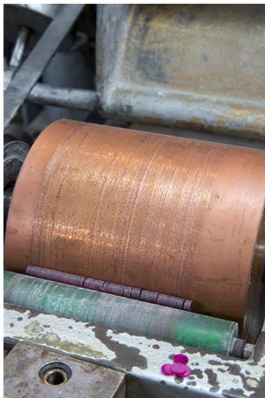
Atelier de taille du rubis : cylindre diamanté d'une machine. Les carrelots de rubis synthétique sont arrondis en frottant sur le cylindre.
