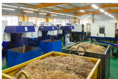
Bennes à copeaux de laiton,
