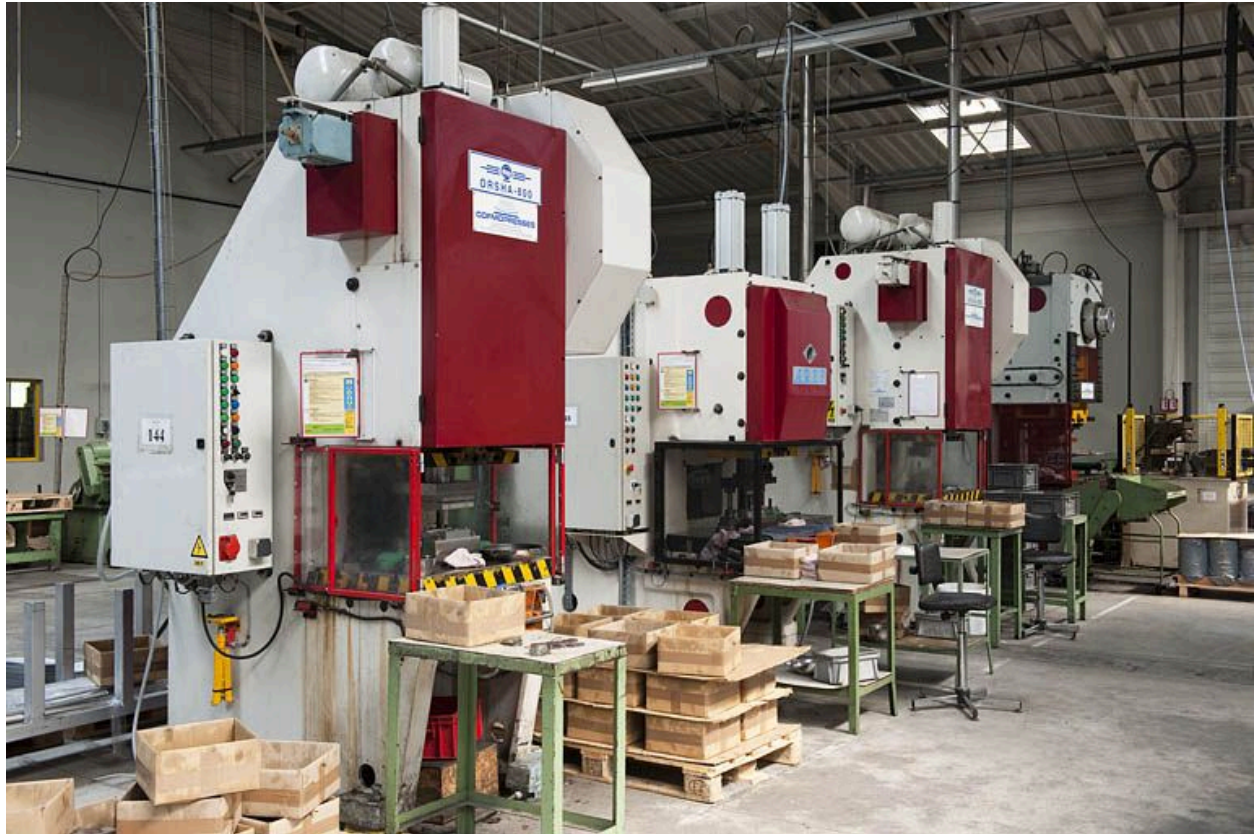
Fesches-le-Châtel, usine de ferblanterie dite la Casserie, puis usine de petite métallurgie Japy Frères et Cie, actuellement Cristel : atelier d'emboutissage. Batterie de presses.
