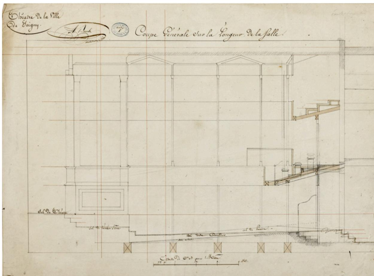
Construction de la salle de spectacle. Coupe générale sur la longueur [sic] de la salle. Pour le charpentier. 1832.
