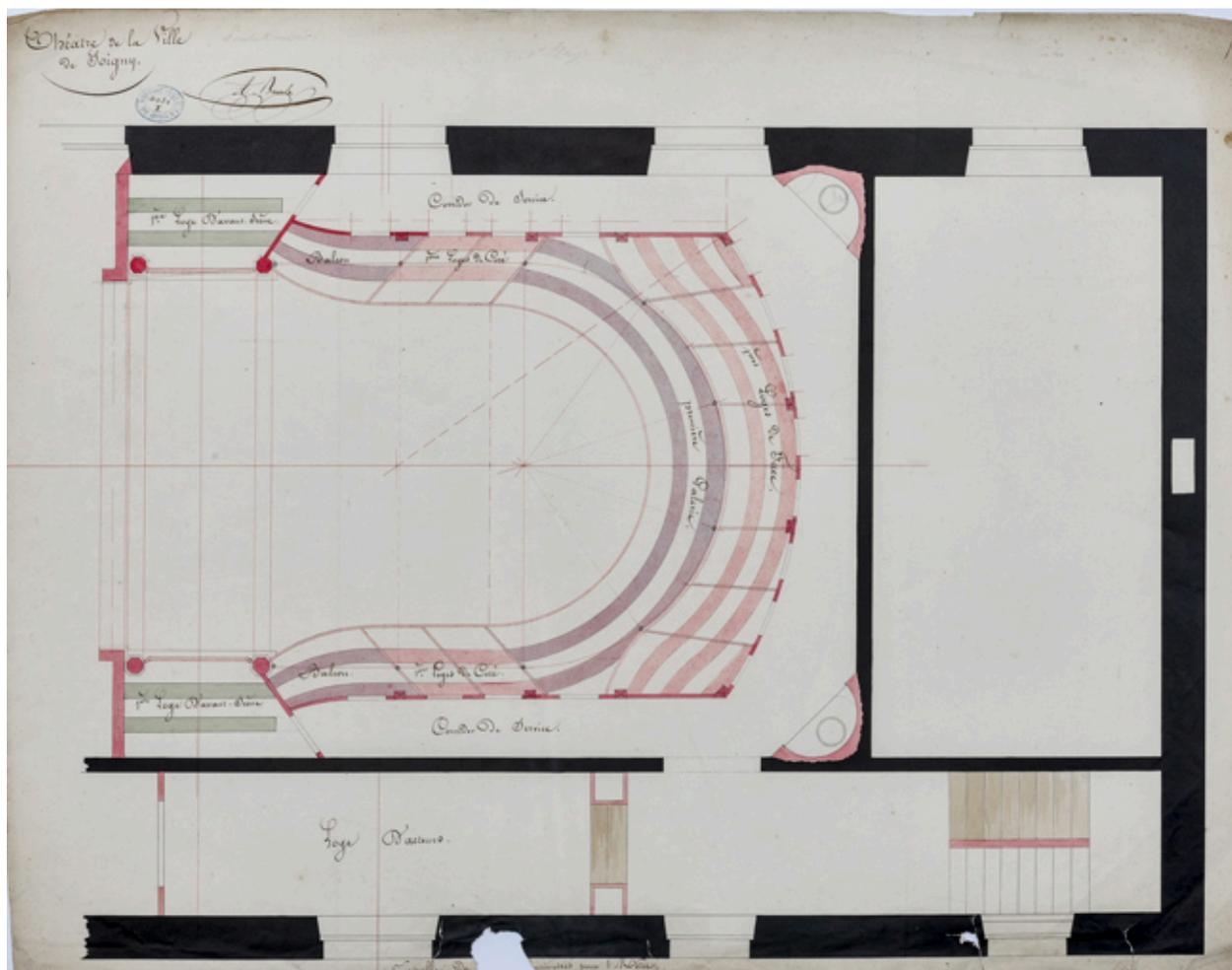
Construction de la salle de spectacle. [1er étage : loges et banquettes]. Pour le menuisier. 1832.
