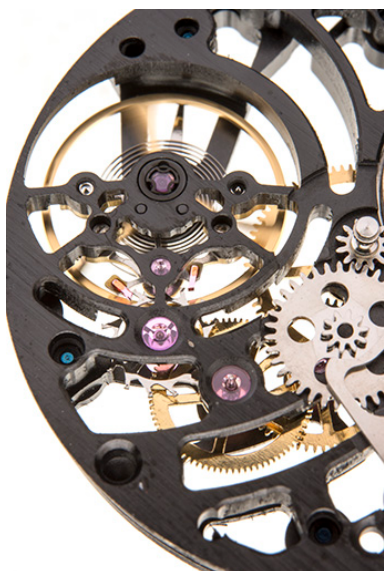
Mouvement noir, détail : amortisseur de choc, côté cadran. Phot. Sonia Dourlot IVR43_20182501158NUC4A
