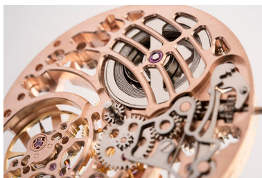
Mouvement rose, détail côté cadran : amortisseur de chocs (à gauche), tirette et pont de barillet (avec ressort moteur). Phot. Sonia Dourlot IVR43_20182501164NUC4A
