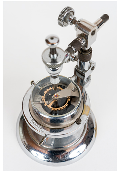
Machine à compter les spiraux (ou machine à régler), par Michel Caille à Villers-le-Lac, 2e quart 20e siècle. Phot. Sonia Dourlot IVR43_20162501345NUC4A
