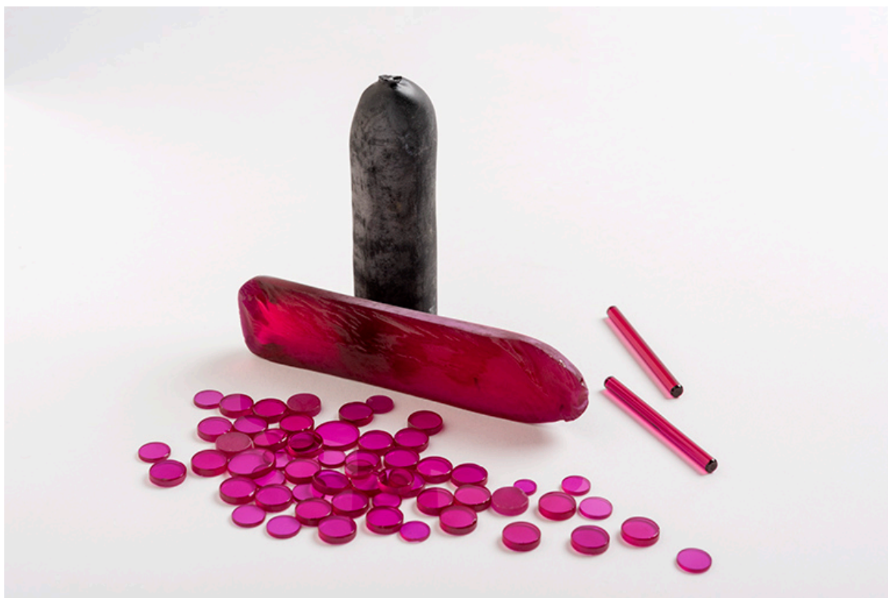
Boules (ou poires) de rubis synthétiques, baguettes et rondelles réalisées à l'usine Rubis-Précis, à Charquemont.
