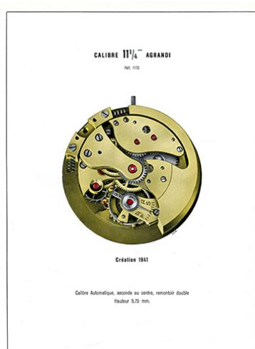
Calibre 11 1/4''' agrandi. Ref. 1173. Création 1941. Calibre Automatique, seconde au centre, remontoir double. Hauteur 5,75 mm, 1949. Autr. Lux IVR43\_20152500142NUC4A
