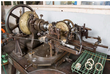
Machine à graver (machine à guillocher), par Lienhard à La Chaux-de-Fonds, 1904. Phot. Sonia Dourlot IVR43_20182501126NUC4A
