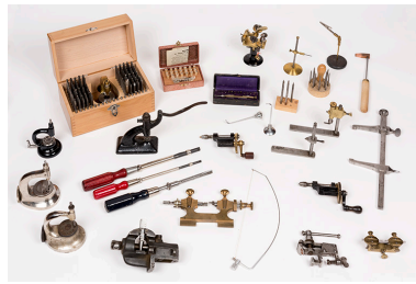
Outils produits dans la commune des Gras (collection René Laithier, mairie des Gras), 19e et 20e siècles : potences, estrapades, tours, étaux, compas aux engrenages, etc. Phot. Sonia Dourlot IVR43_20172500489NUC4A
