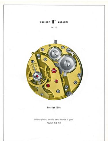
Calibre 11''' agrandi. Ref. 111. Création 1904. Calibre cylindre, bascule, sans seconde, à ponts. Hauteur 4,75 mm, 1949. Autr. Lux IVR43\_20152500140NUC4A
