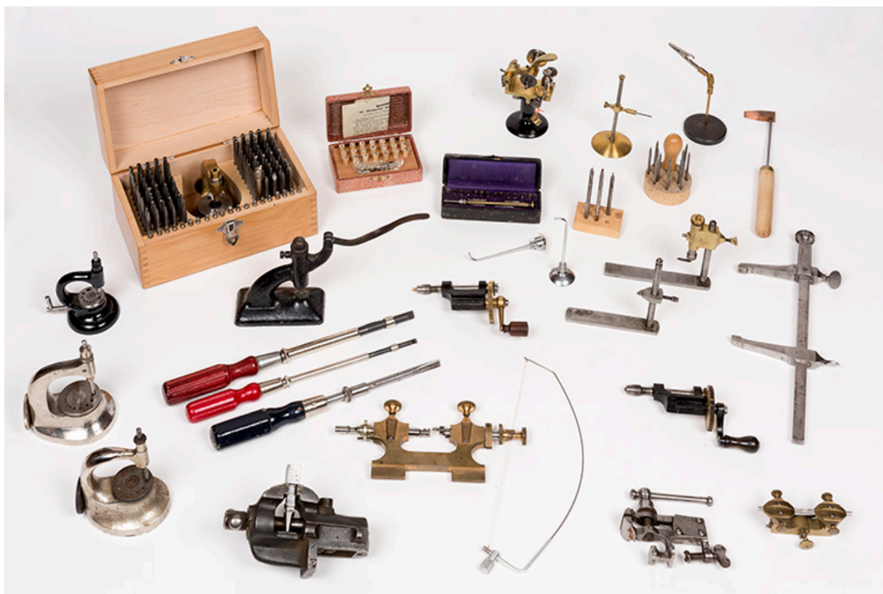
Outils produits dans la commune des Gras (collection René Laithier, mairie des Gras), 19e et 20e siècles : potences, estrapades, tours, étaux, compas aux engrenages, etc.
