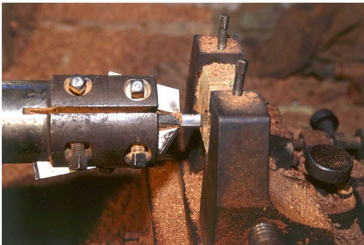
Détail de la mèche et du support de la tête de pipe.
