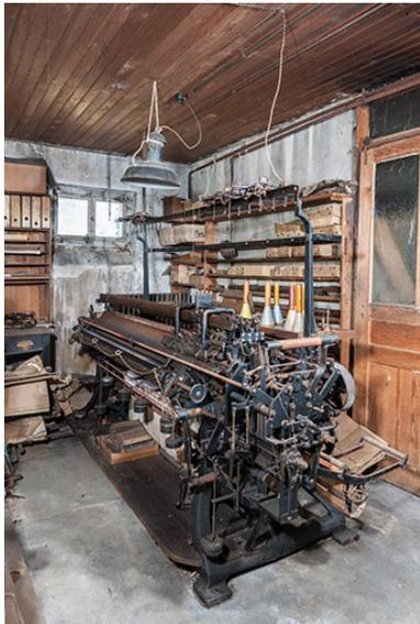
Machine à tricoter à plat.
