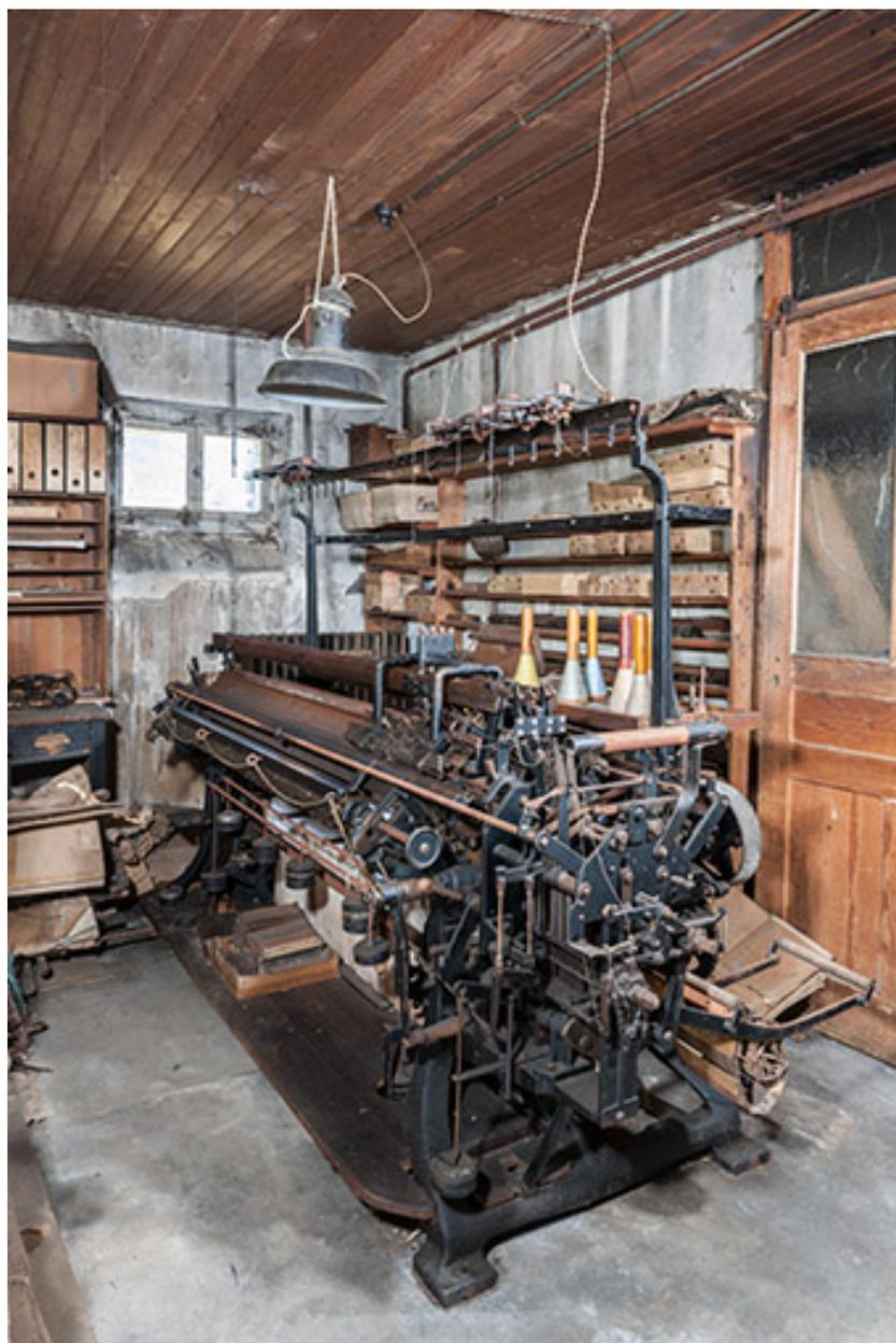
Machine à tricoter à plat.
