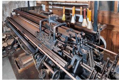
Machine à tricoter à plat (détail).
