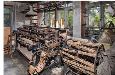
Machine à tricoter à plat (métier
