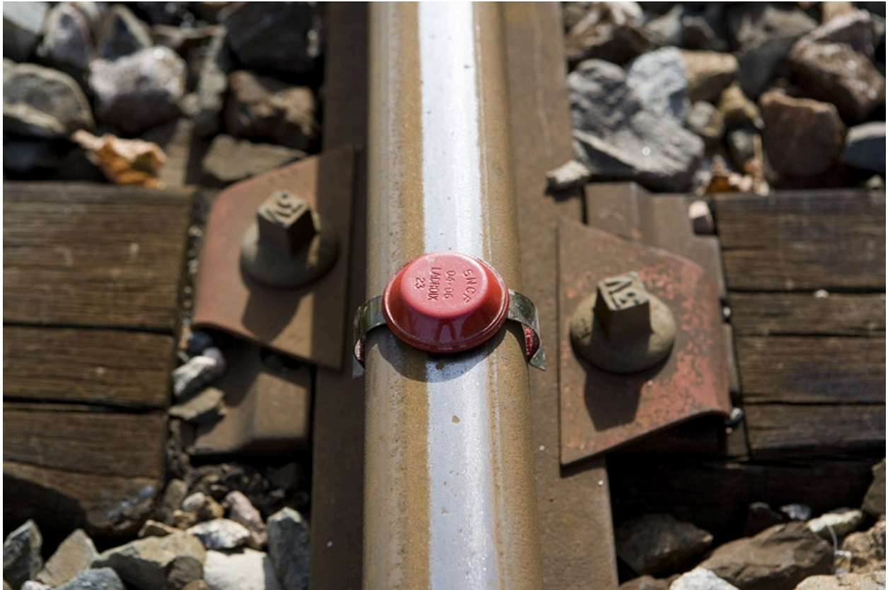
Vue rapprochée d'un pétard fixé sur un rail.
